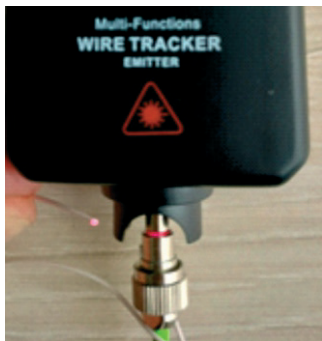
Рисунок 12 – Проверка оптического волокна на обрыв
