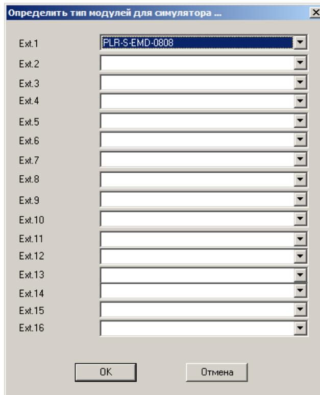
Выбрав модули нажмите ОК, и повторите вызов симулятор заново. Если программа не содержит критических ошибок, симулятор запустится. При этом связи и блоки в рабочей области будут подсвечены цветом в зависимости от состояния, а в нижней части рабочей области будет выведена панель управления ходом выполнения программы.
