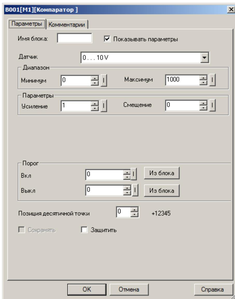
В случае если пороговые значения необходимо определить, как переменные значения, необходимо активировать функцию "Из блока" и указать функциональный блок программы, значение которого будет использоваться в качестве уставки.
