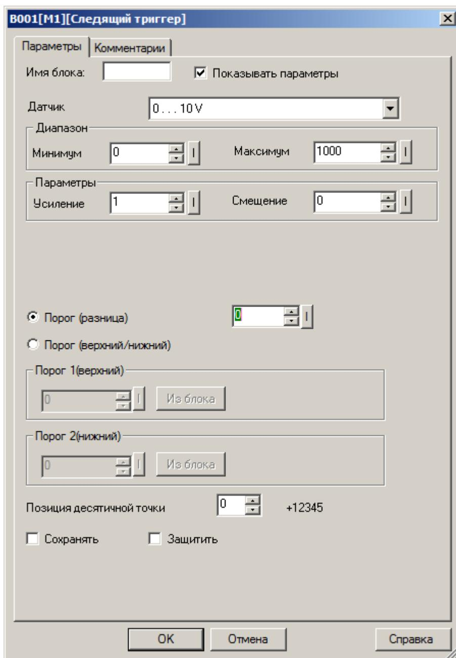
В случае если пороговые значения необходимо определить, как переменные значения, необходимо активировать функцию "Из блока" и указать функциональный блок программы, значение которого будет использоваться в качестве уставки.
