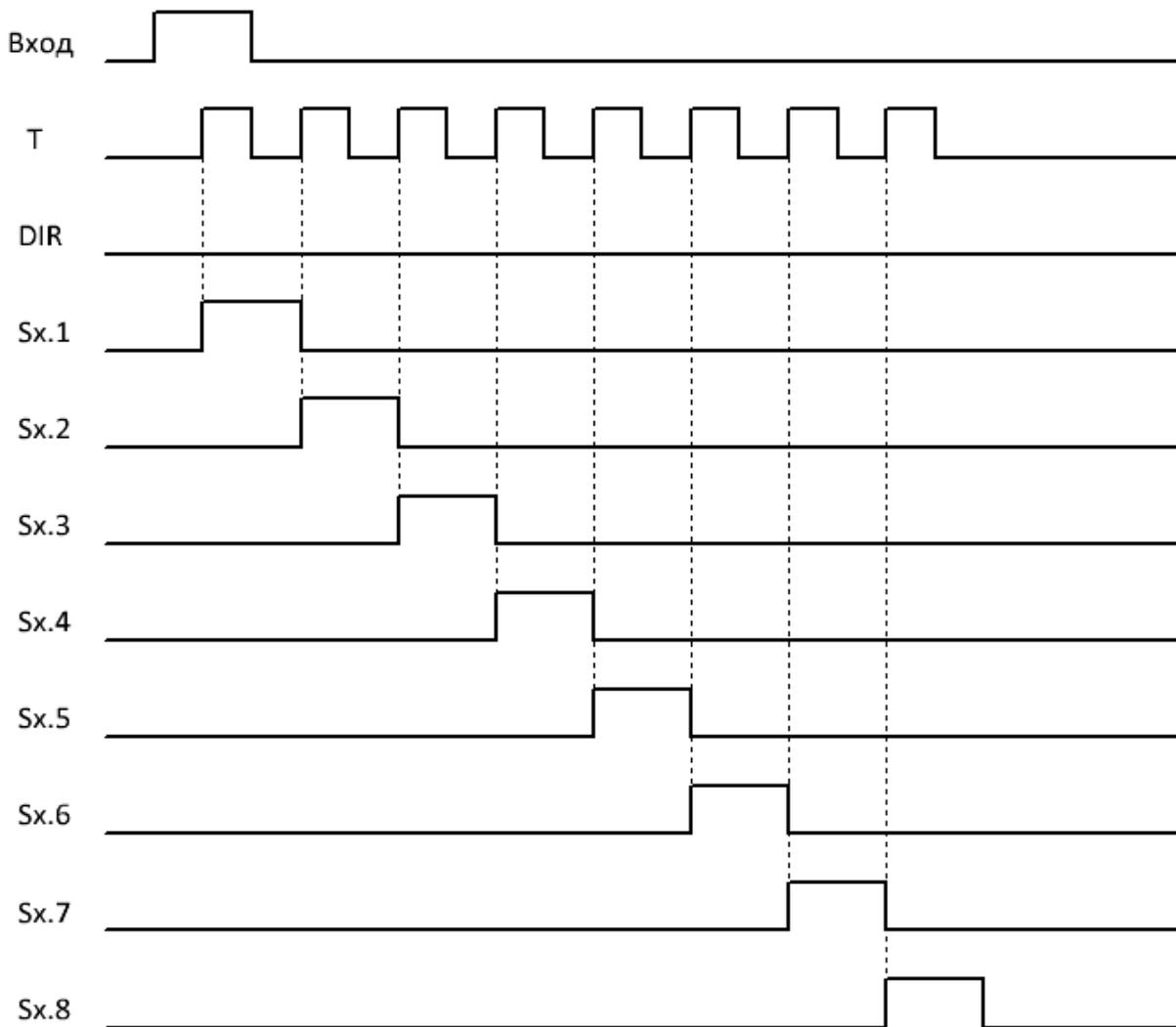
На вкладке "параметры" в окне свойств блока можно определить индекс сдвигового регистра (количество регистров в программе ограничено возможностями модуля ЦПУ) и номер бита значение которого транслируется на выход.
