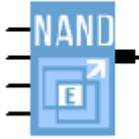
Выход блока переключается в состояние логической единицы на один цикл программы, если логический ноль действует хотя бы на одном входе блока, при условии, что все входы были в состоянии логической единицы в течении предыдущего цикла программы.
