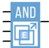
Выход блока переключается в состояние логической единицы на один цикл программы, только если логическая единица действует на всех входах блока одновременно, но при условии, что по крайней мере один вход был в состоянии логического нуля в предыдущем цикле программы.
