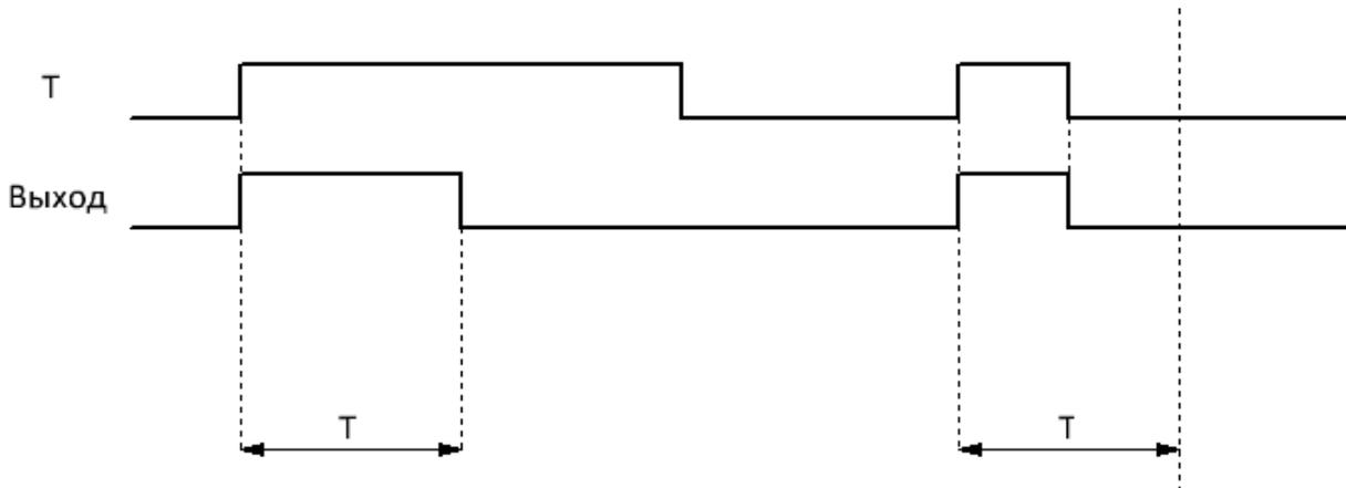
Уставка длительности импульса (T) задается на вкладке "параметры" в окне свойств блока, и может быть определена как постоянная, или как переменная величина.
