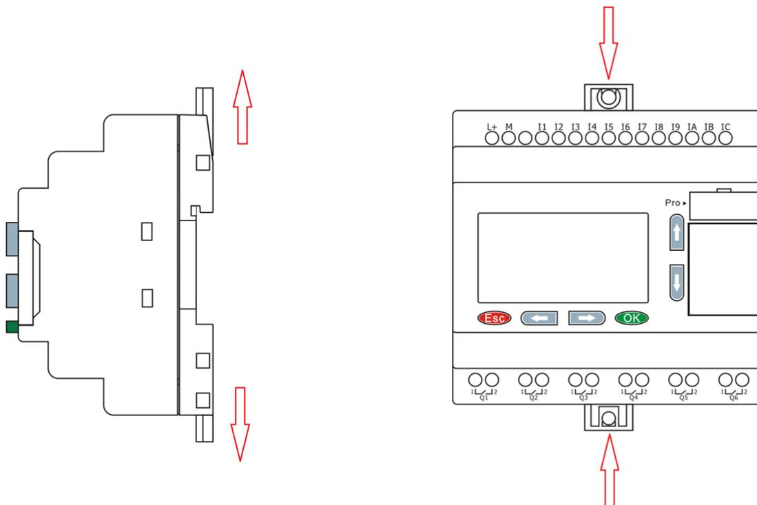
Аналогичным образом закрепите модули расширения справа от модуля ЦПУ и соедините модули при помощи шлейфовой перемычки. Для доступа к соединительным разъемам необходимо открыть пластиковые защитные крышки на соединяемых модулях.
