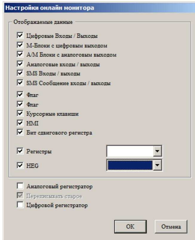
Далее отметьте типы данных которые необходимо отобразить в онлайн мониторе или снимите отметки с данных которые можно скрыть.
