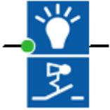
При обнаружении фронта нарастающего сигнала на входе Т, функциональный блок формирует логическую единицу на выходе в течении времени, заданного уставкой Т.
