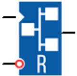
При появлении сигнала логической единицы на входе EN, блок выполняет операцию чтения по протоколу Modbus с периферийного устройства (Slave), подключенного посредством одного из коммуникационных интерфейсов COM0-COM2.
