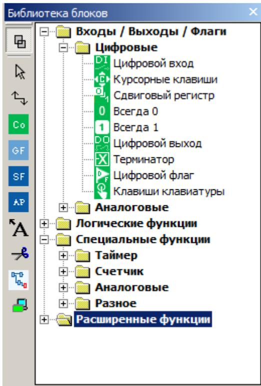
В окне библиотеки блоков графически представлены все доступные пользователю функциональные блоки, применяемые при создании управляющих программ. Для удобства навигации и доступа, все блоки сгруппированы по функциональному признаку.
