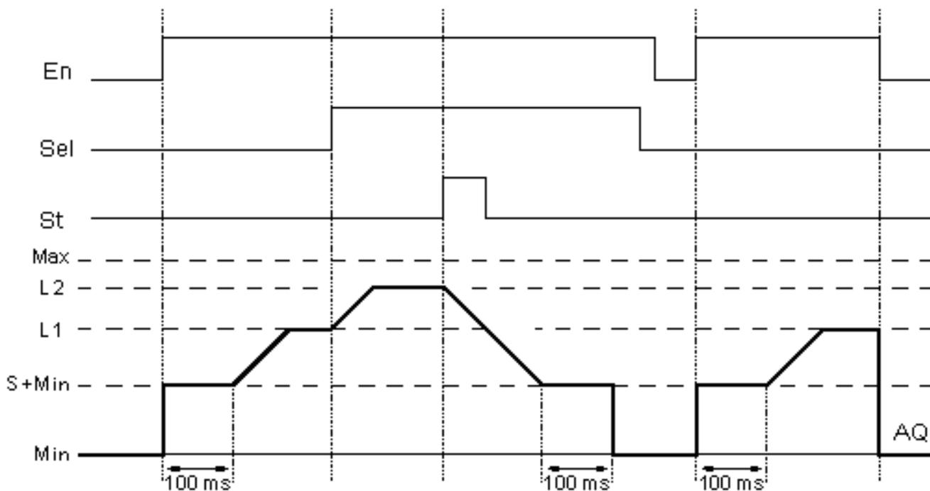
Скорость изменения нарастающего сигнала на выходе, начальное смещение (S) и конечные уровни L1 и L2 задаются на вкладке "Параметры" в окне свойств блока.
