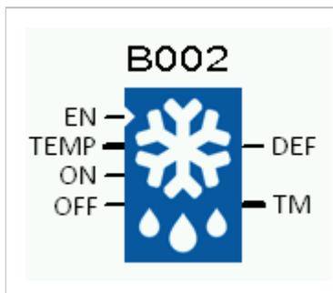
Выход DEF блока разморозки переключается на 1, когда температура на входе ниже минимальной температуры в течение совокупного времени. Если температура поднимается выше максимальной температуры во время цикла разморозки, выход DEF возвращается в состояние OFF, даже если оно еще не завершено. Этот выход можно активировать или выключить вручную, с помощью соответствующих входов ON и OFF.
