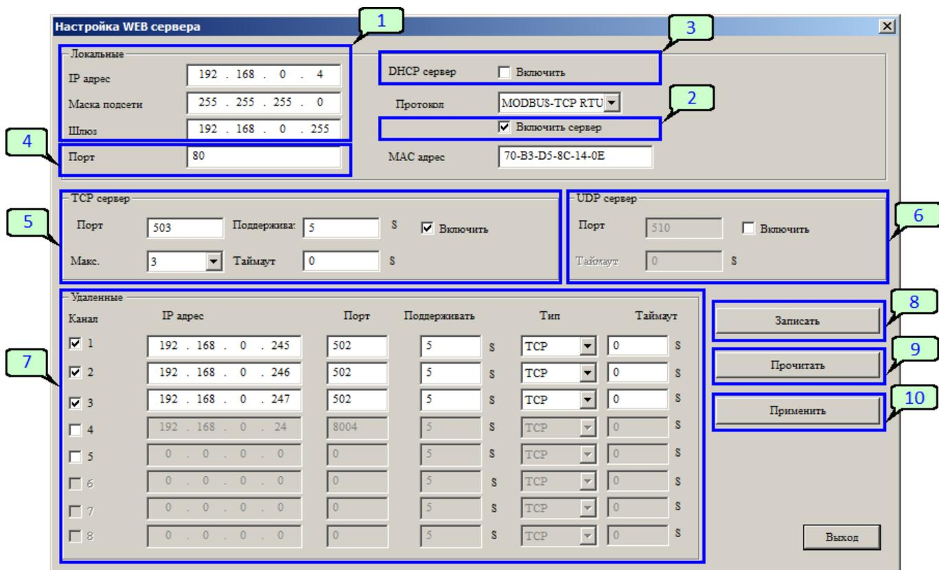
Разделы [5] и [6] служат для настройки возможности подключения по протоколам TCP и UDP и номеров портов по которым внешние устройства будут обращаться к настраиваемому устройству. Для протокола TCP дополнительно указывается количество допускаемых одновременных подключений, которое влияет также на количество обслуживаемых внешних узлов в режиме "Клиент".
