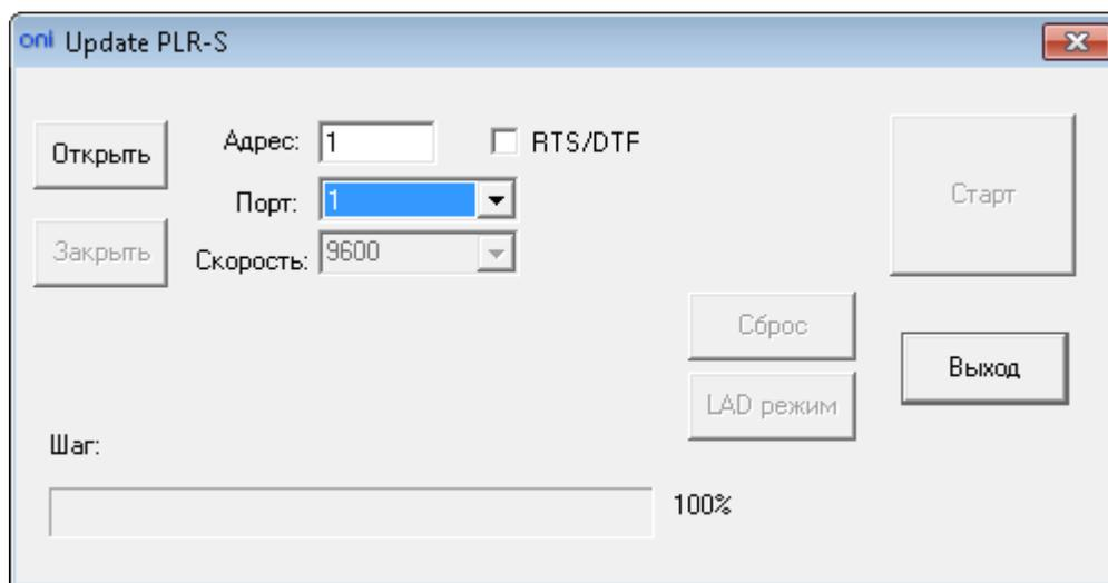
Укажите номер порта, проверьте, что адрес PLR-S соответствует адресу в строке "Адрес". Нажмите кнопку "Открыть", затем нажмите "Старт". Пойдет процесс обновления. По окончании логическое реле автоматически перезагрузится.
