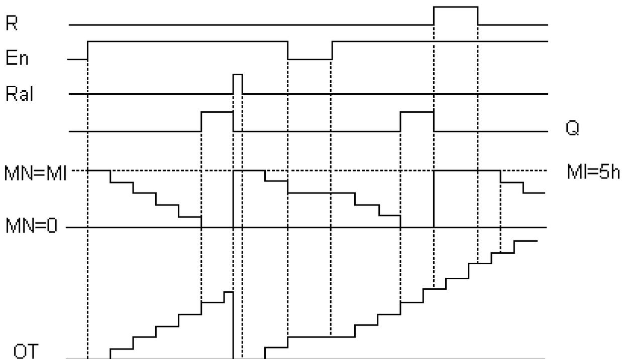
Начальные значения счетчиков устанавливаются на вкладке "параметры" в окне свойств блока, и могут быть определены как постоянные, или как переменные величины. Диапазон значений для предустановки счетчика межсервисных интервалов составляет 9999 часов.
