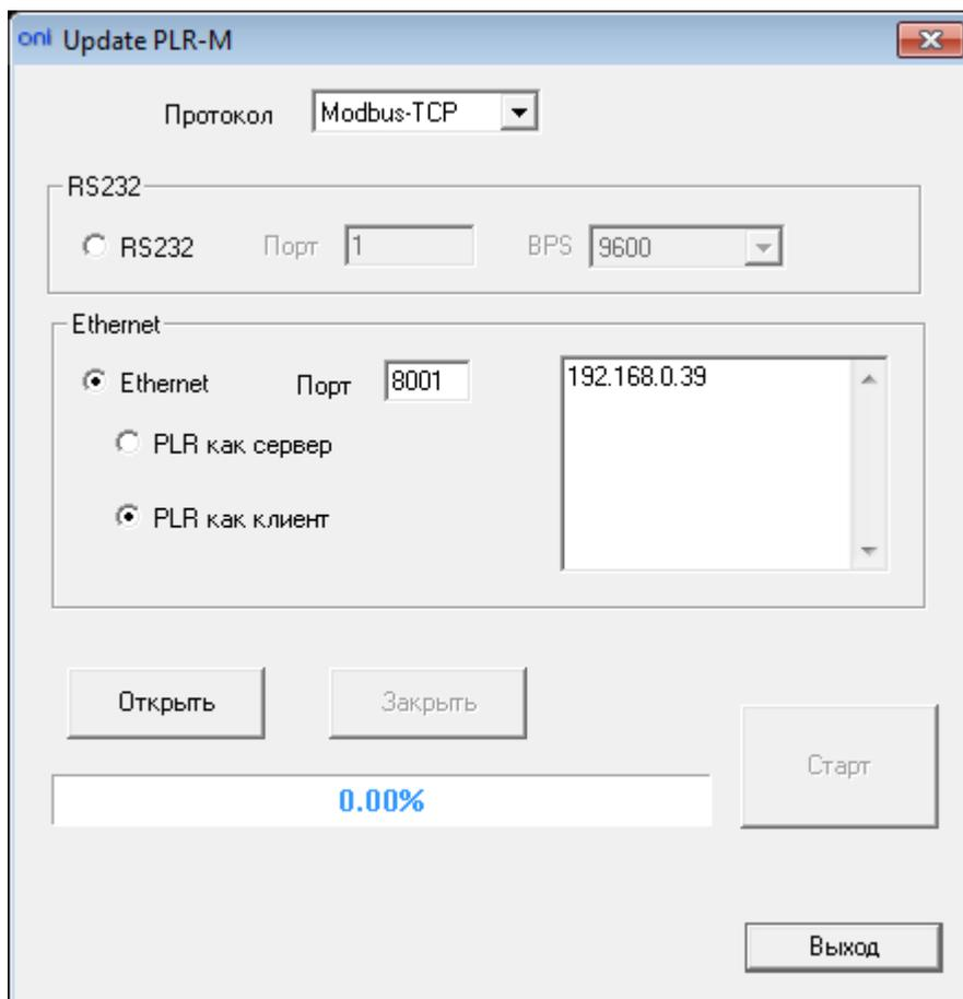
Нажмите кнопку "Открыть", затем нажмите "Старт". Согласитесь на обновление. Пойдет процесс обновления. По окончании ПЛК автоматически перезагрузится.
