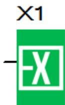
Блок терминатора используется для подключения незадействованных цифровых выходов, например, у блоков специальных функций в случаях, когда их недопустимо оставлять неподключенными, а функционально они не востребованы.
