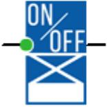
Комбинированный функциональный блок, сочетающий в себе функционал таймеров задержки включения и задержки выключения сигнала на выходе при соответствующих изменениях состояния входа Т. Временные задержки работы таймера определяются уставками TH и TL.
