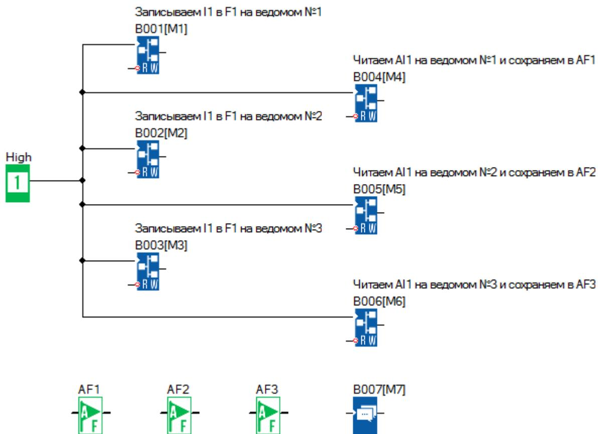
Блок В001 передает состояние цифрового входа I1 в цифровой флаг F1 (Modbus адрес 0x1536) ведомого №1 (192.168.0.101):
