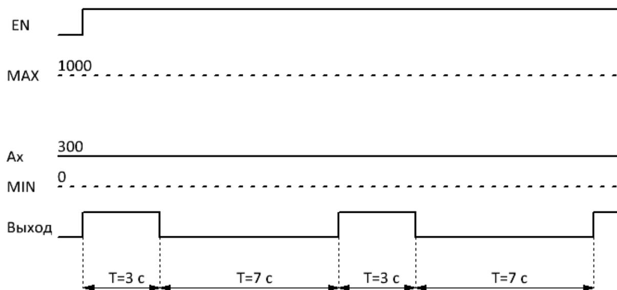
Длительность импульса можно рассчитать по формуле:  $T_{имп} = (A_x - MIN) / (MAX - MIN) * T$ , где T период сигнала, MAX и MIN пределы значений входного сигнала, обрабатываемого блоком.
