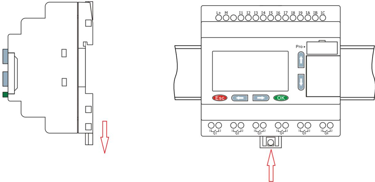
Аналогичным образом закрепите модули расширения справа от модуля ЦПУ и соедините модули при помощи шлейфовой перемычки. Для доступа к соединительным разъемам необходимо открыть пластиковые защитные крышки на соединяемых модулях.
