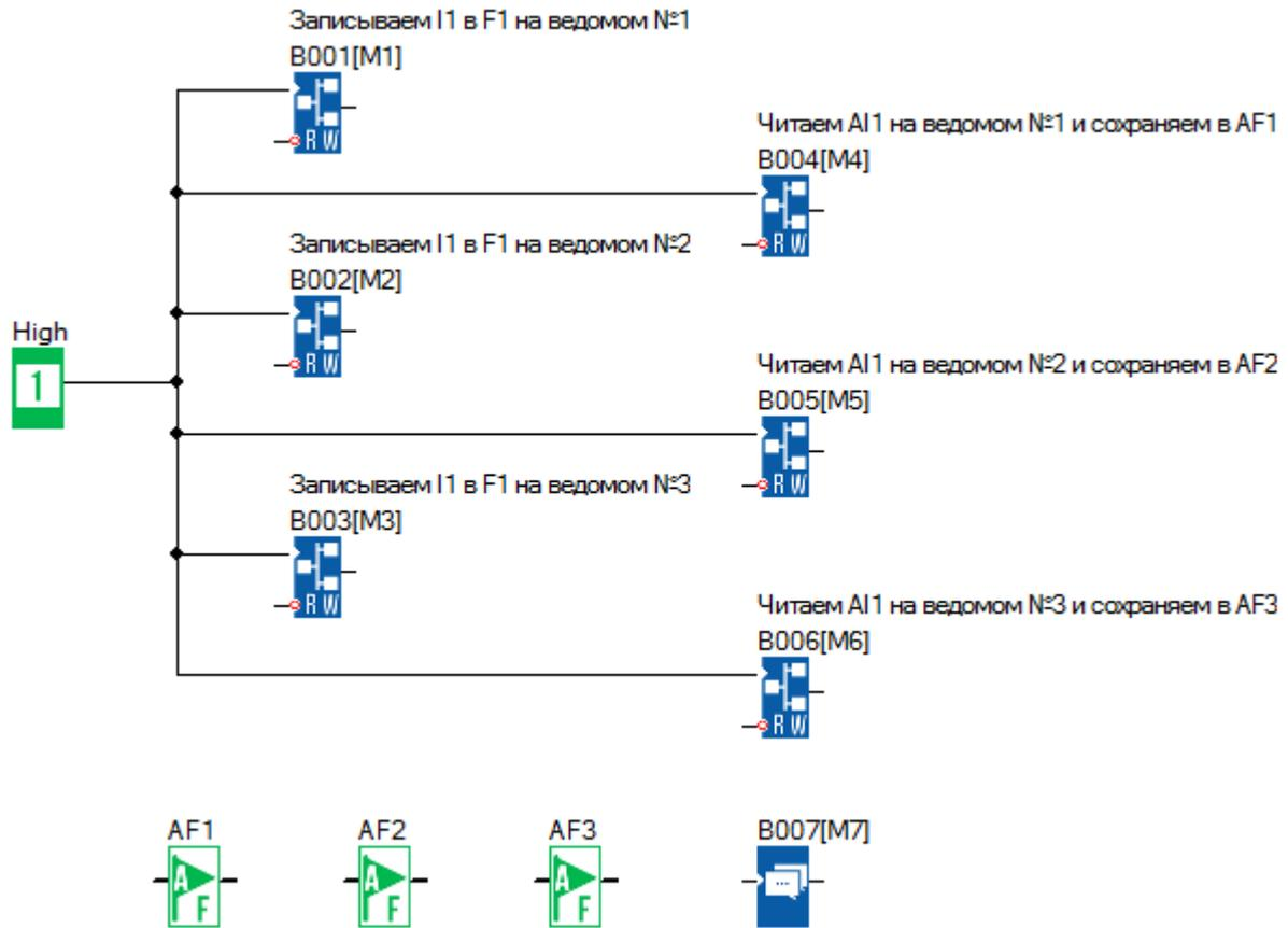
Блок В001 передает состояние цифрового входа I1 в цифровой флаг F1 (Modbus адрес 0x1536) ведомого №1 (192.168.0.101):
