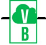
Этот блок обеспечивает хранение 8-битных данных или один символ с использованием ASCII кода символа, который можно использовать в коммуникациях MQTT, либо выводе динамических надписей или числовых значений на встроенный экран.
