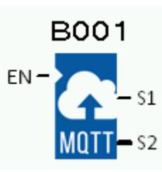
После успешного подключения ПЛК к MQTT серверу, активирование этого блока позволяет опубликовать сообщение в теме на сервере MQTT.
