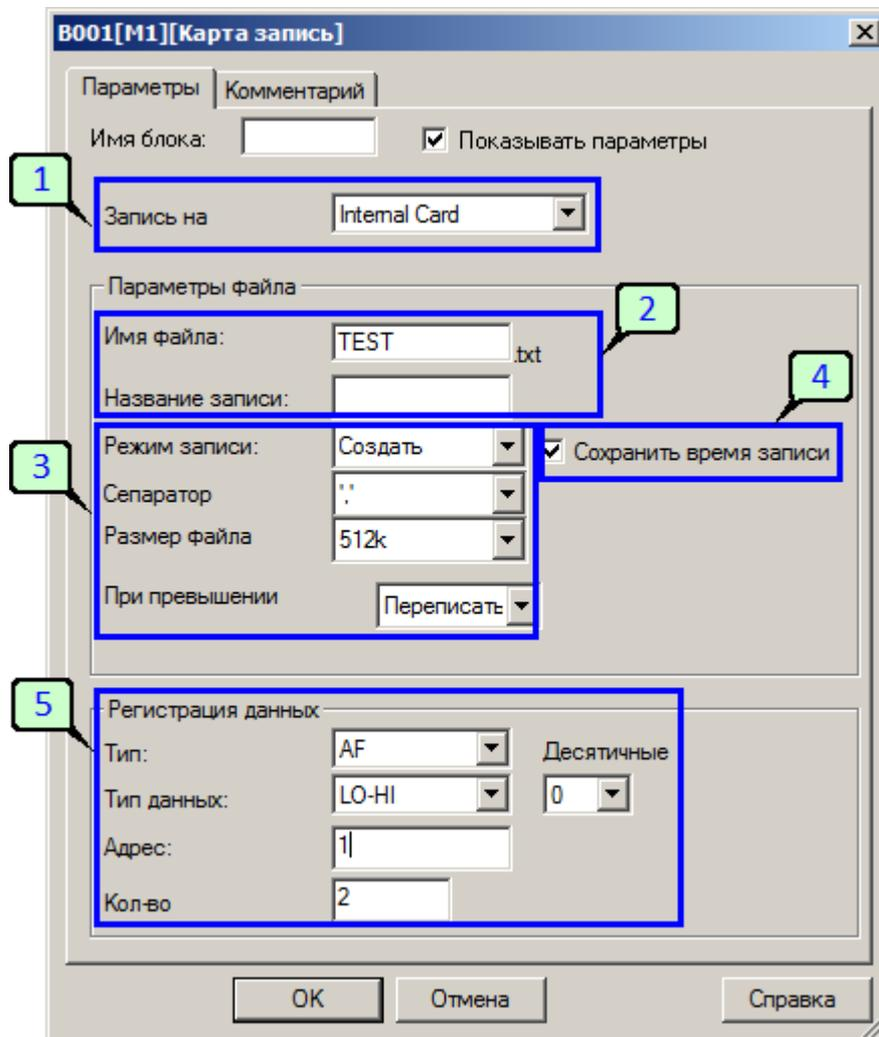
Для настройки данных, которые будут записаны в файл при вызове блока служит поле [5], здесь указывается источник данных, порядок следования, адрес и количество регистров подряд данные из которых будут записаны в файл. Дополнительно можно указать позицию десятичной точки если блок выполняет обработку аналоговых величин.
