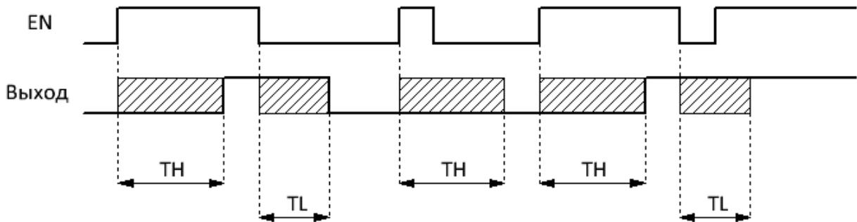
Уставки максимальной длительности задержки включения TH и максимальной длительности задержки выключения TL задаются на вкладке "параметры" в окне свойств блока. Временные уставки могут быть определены как постоянные, или как переменные величины.
