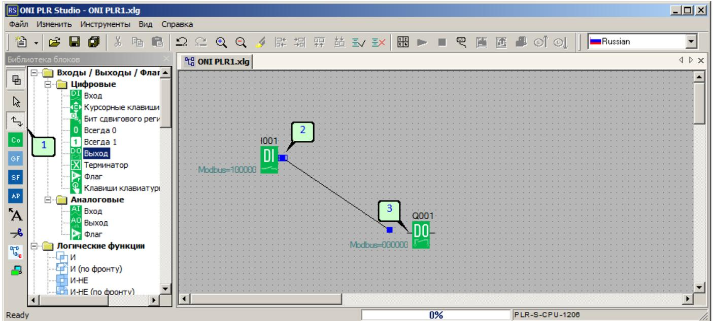
Отпустите кнопку мыши, связь будет установлена. При необходимости размещение блоков и связей можно корректировать с помощью указателя мыши, для лучшего отображения и удобства чтения программы.
