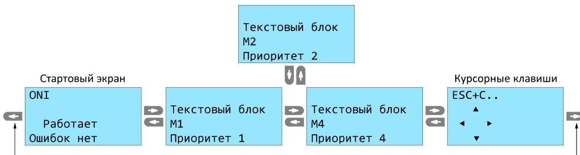
При поступлении сигналов одновременно на входы I001, I002, отобразиться блок М3, так как он имеет больший приоритет по отношению к блоку М2. При этом пользователь может перемещаться клавишами "вверх/вниз" между блоками М2, М3, а клавишами "вправо/влево" между блоками М1, М4:
