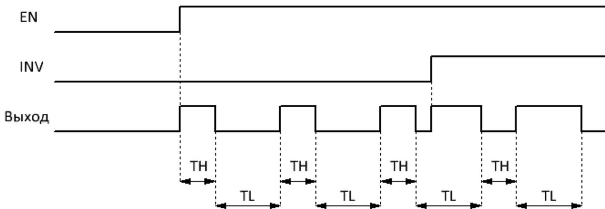
Уставки длительности импульсов ТН и временного интервала между импульсами ТЛ задаются на вкладке "параметры" в окне свойств блока. Временные уставки могут быть определены как постоянные, или как переменные величины.
