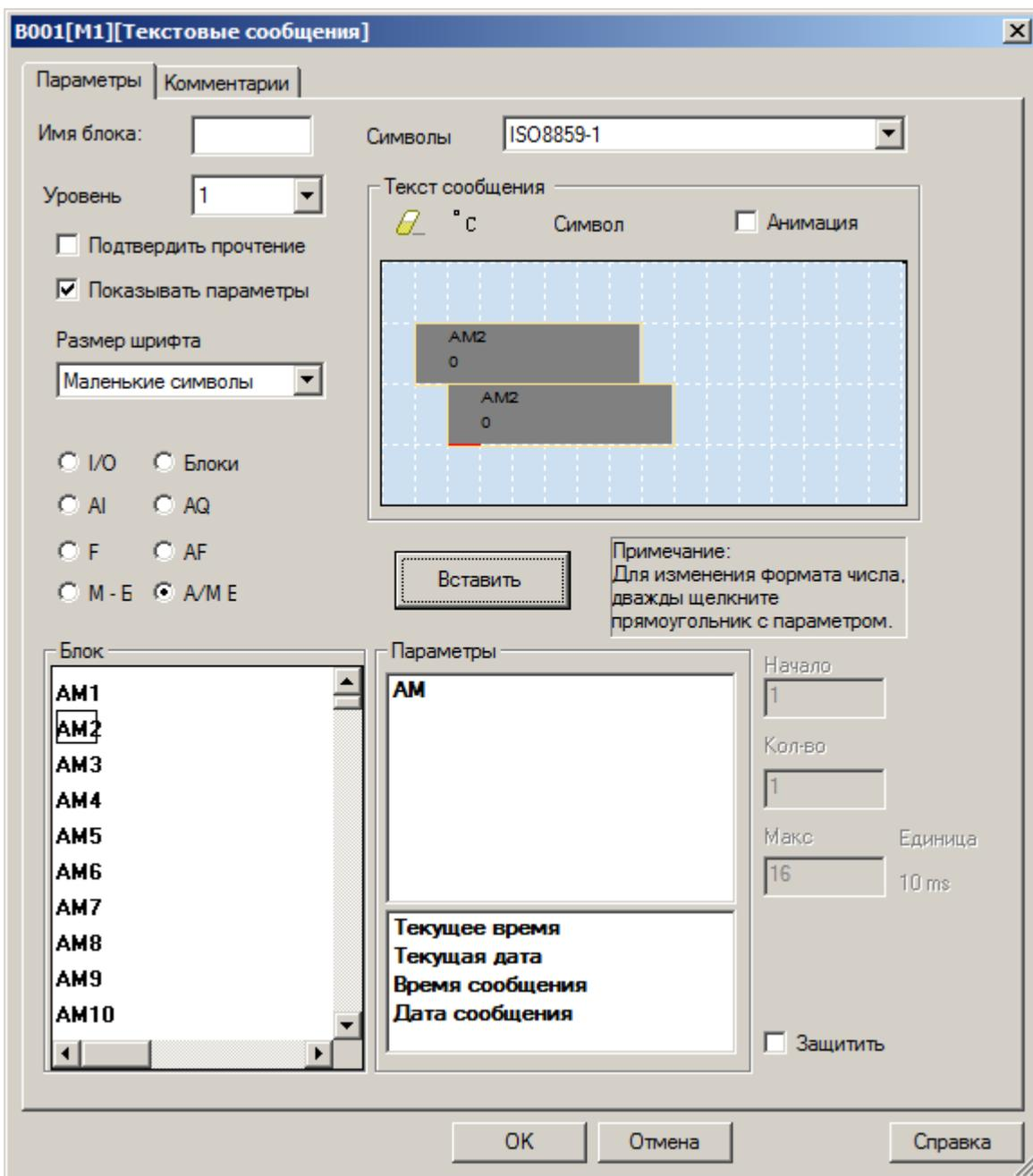
Чтобы добавить поле вывода данных, выберите источник данных в левой части экрана, тип параметра для отображения, затем установите курсор в желаемую позицию модели экрана и нажмите кнопку
