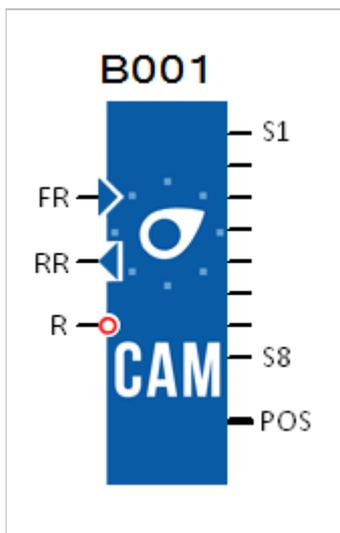
Блок шагового контроллера используется для управления набором из 8-и виртуальных кулачковых контактов, посаженными на один вал.
