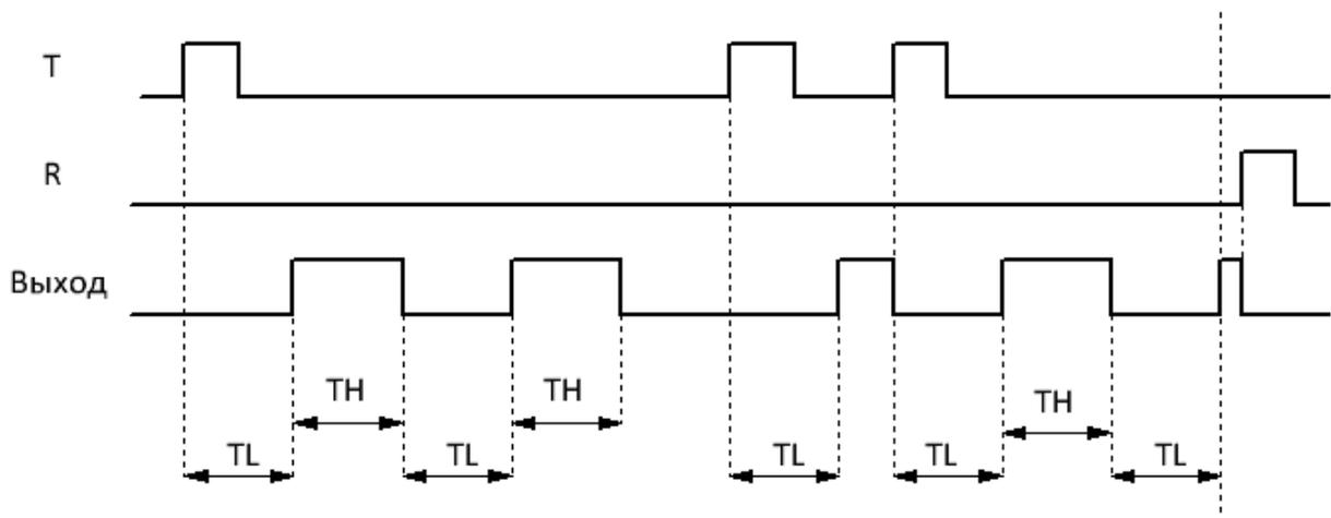
Уставки длительности импульсов TH, временного интервала между импульсами TL и количество импульсов задаются на вкладке "параметры" в окне свойств блока. Временные уставки могут быть определены как постоянные, или как переменные величины.
