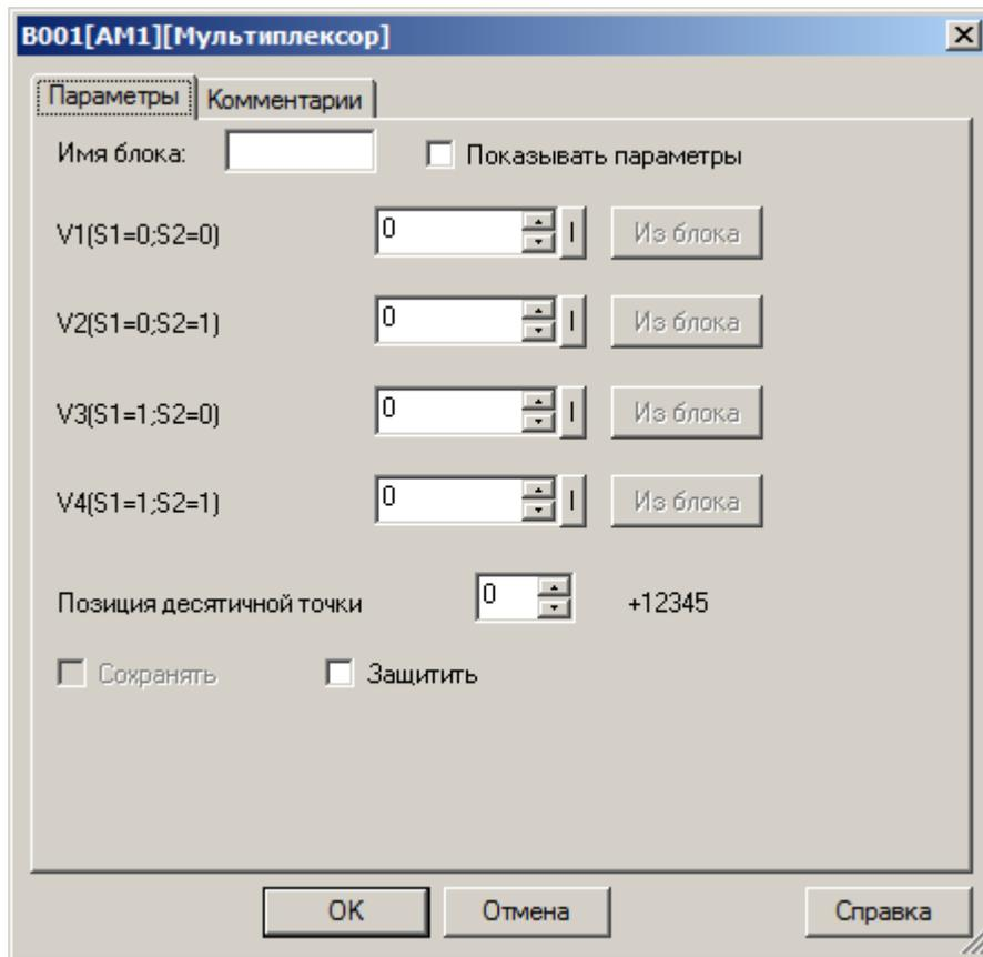
В случае переменных, необходимо активировать функцию "Из блока" и указать функциональный блок, значение которого будет задействовано.
