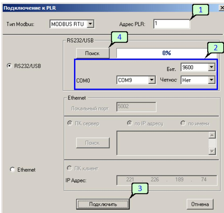
Также можно попробовать установить подключение определив параметры порта автоматически. Для этого нажмите кнопку "Поиск" [4]. Программа выполнит сканирование доступных портов с различными скоростями. Если программа обнаружит устройство и определит его настройки, будет выведено информационное сообщение.
