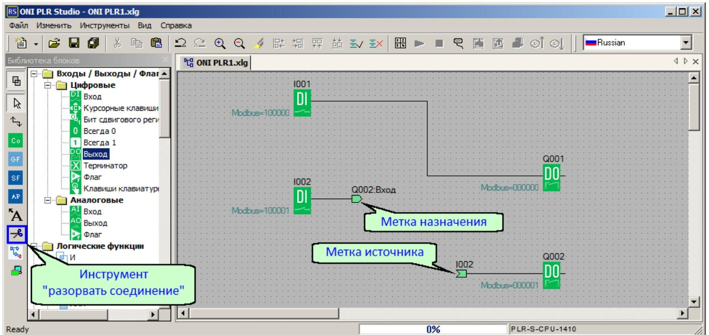
Для формирования разрыва выберите инструмент в окне библиотеки, затем наведите курсор на соединение которое необходимо разорвать и щелкните мышью. Соединение будет преобразовано в адресные ссылки.
