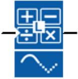
Блок арифметических операций рассчитывает значение выходного сигнала AQ по уравнению, сформированному из определенных пользователем операндов и операторов. В качестве операндов могут быть заданы данные с разрядностью 32 бита.
