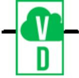
Этот блок обеспечивает хранение 32-битных данных или четыре символа с использованием ASCII кода символа, которые можно использовать для вывода числовых значений различного формата (со знаком, без знака, длинное целое, длинное целое с инверсией или hex-формат) или динамических символьных строк (с помощью VB) на встроенный экран.
