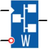
При появлении сигнала логической единицы на входе EN, блок выполняет операцию записи по протоколу Modbus в периферийное устройство (Slave), подключенное к модулю ЦПУ посредством одного из коммуникационных интерфейсов COM0-COM2.
