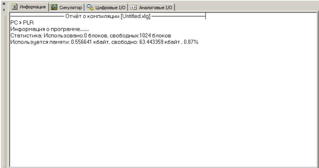
На вкладке "Симулятор" моделируется выбранное оборудования и его состояние при использовании симулятора для отладки проекта.
