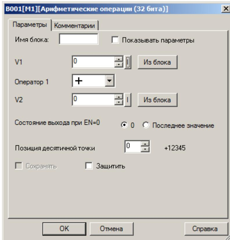
Операнды могут быть определены как постоянные или переменные величины. В случае использования переменных, необходимо активировать функцию "Из блока" рядом с настраиваемым параметром и указать функциональный блок, значение которого будет использоваться в качестве операнда.
