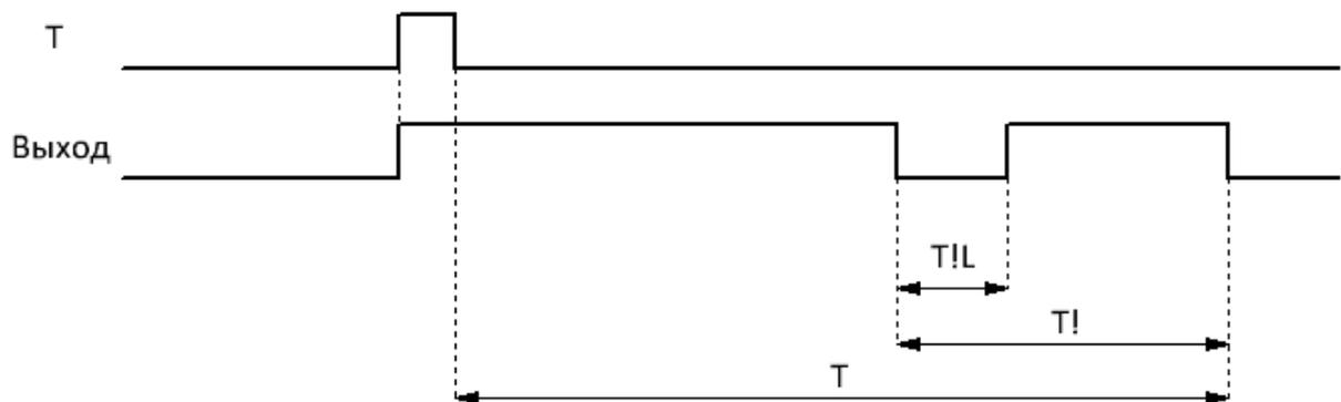
Уставки времени задержки T, времени предупреждения T! и длительности предупреждения T!L задаются на вкладке "параметры" в окне свойств блока. Функцию предупреждения можно отключить, задав вручную 0 в качестве уставки T!. Временные уставки могут быть определены как постоянные, или как переменные величины.
