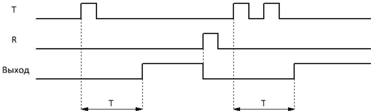
Уставка задержки включения (T) задается на вкладке "параметры" в окне свойств блока, и может быть определена как постоянная, или как переменная величина.
