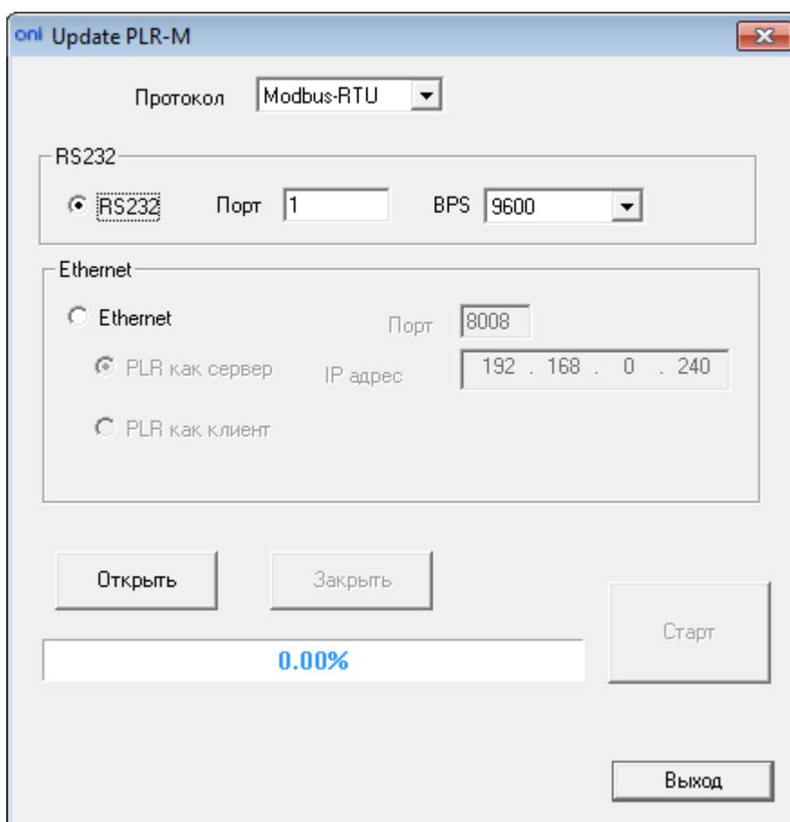
Нажмите кнопку "Открыть", затем нажмите "Старт". Пойдет процесс обновления. По окончании ПЛК автоматически перезагрузится.
