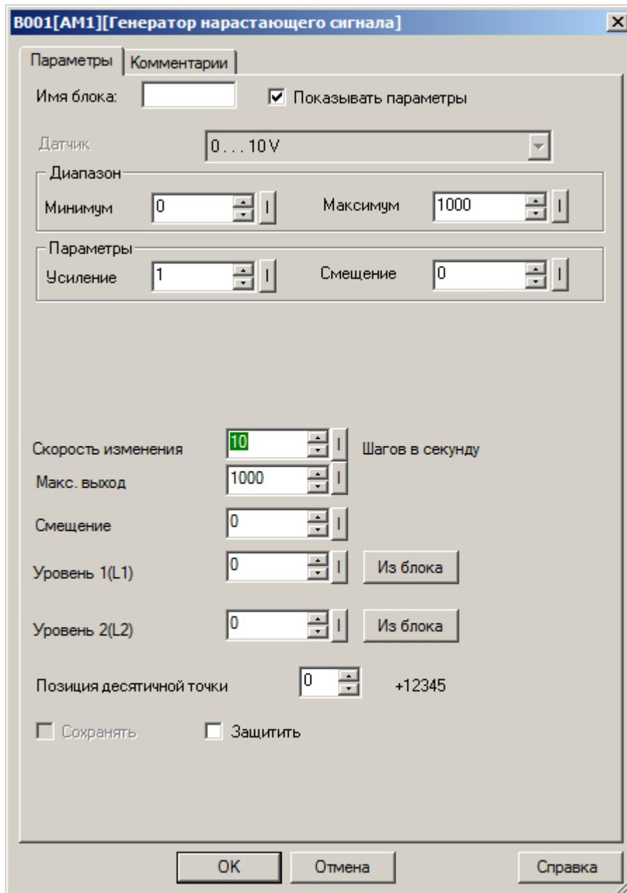
Конечные уровни сигнала могут быть определены как постоянные или переменные величины. В случае использования переменных, необходимо активировать функцию "Из блока" рядом с настраиваемым параметром и указать функциональный блок, значение которого будет использоваться в качестве параметра.
