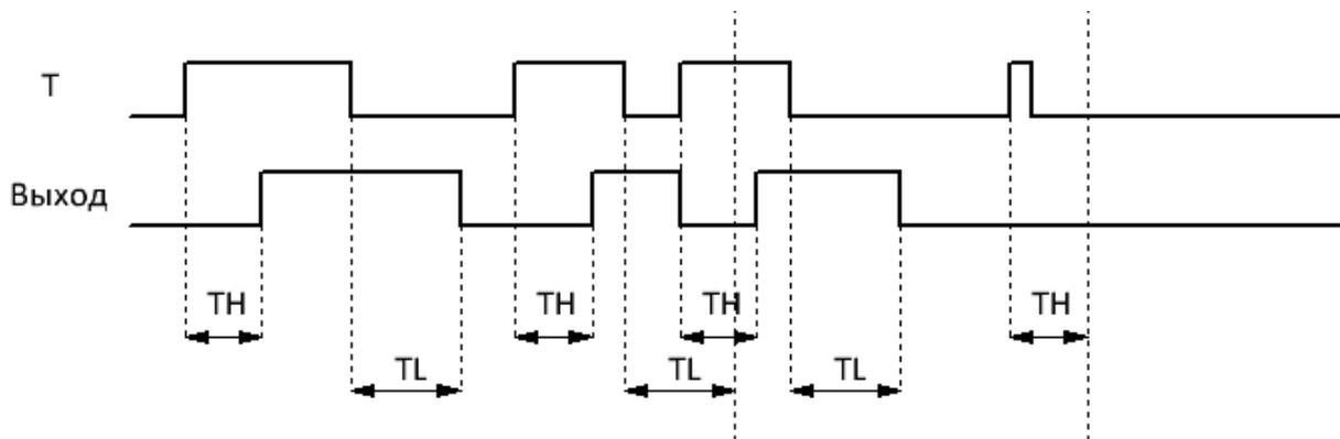
Уставки TH и TL задаются на вкладке "параметры" в окне свойств блока, и могут быть определены как постоянные, или как переменные величины.
