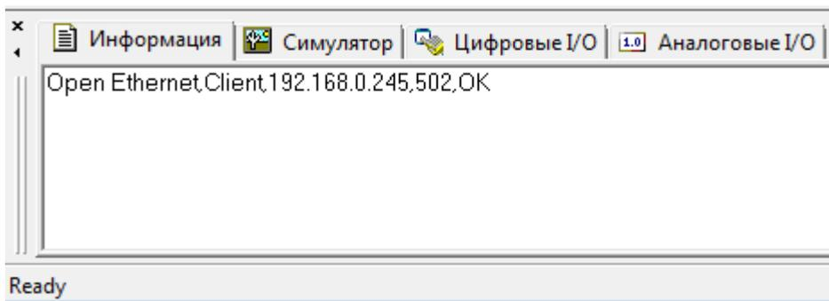
После установления соединения, можно [загружать/выгружать](#) программу, использовать [онлайн-монитор](#) так же, как и при использовании USB кабеля.
