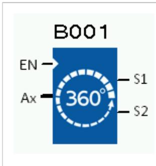
Блок углового контроллера используется для задания логики работы двух дискретных выходов S1 и S2, на основании угла поворота в качестве аналогового входа Ax. Можно выбрать количество шагов, и каждый шаг соответствует 2 настраиваемым выходам.
