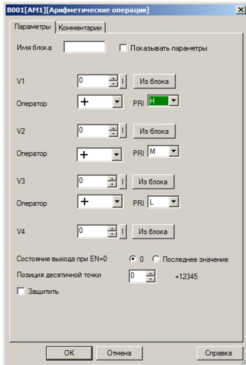
Операнды могут быть определены как постоянные или переменные величины. В случае использования переменных, необходимо активировать функцию "Из блока" рядом с настраиваемым параметром и указать функциональный блок, значение которого будет использоваться в качестве операнда.
