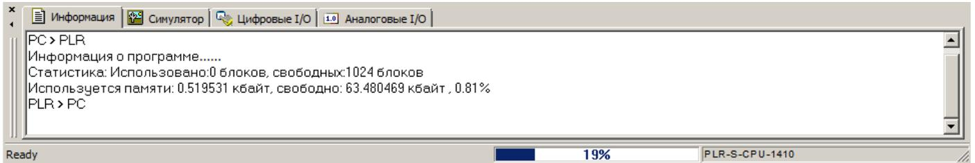
По окончании выгрузки будет создан новый проект в который помещена выгруженная программа. Однако если в исходном проекте программа была защищена паролем, программа попросит ввести его для начала выгрузки.
