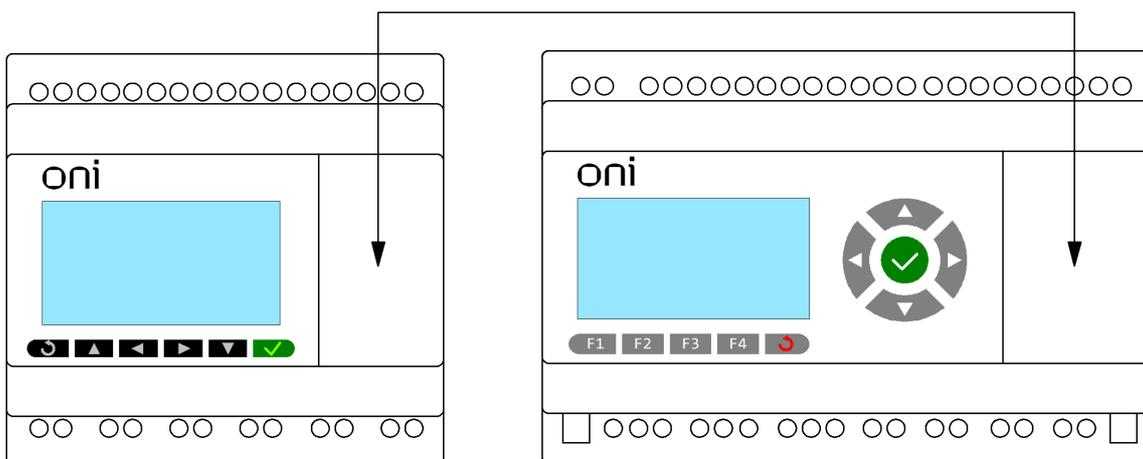
Порт, расположенный в данном гнезде, имеет наименование COM0. Он может использоваться как для загрузки программ в PLR, так и для обмена данными с другими устройствами как стандартный порт RS232. Для использования в качестве стандартного порта RS232, необходимо использовать кабель PLR-S-CABLE-RS232. При наличии экрана и клавиатуры, настройки данного порта можно задать через встроенное [системное меню](#).
