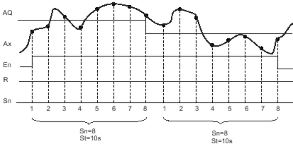
Временной интервал расчета и количество выборок значений задаются на вкладке параметры в окне свойств блока.
