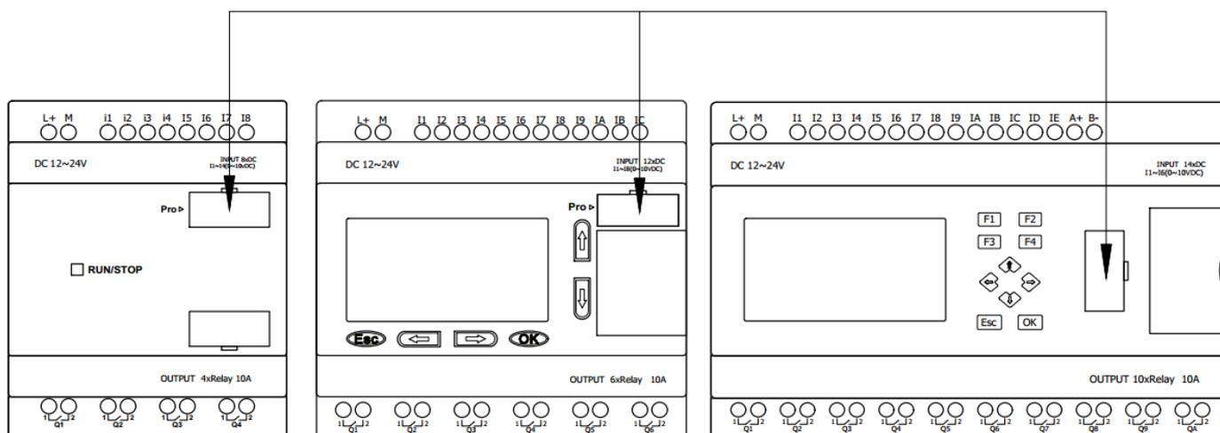
Порт, расположенный в данном гнезде, имеет наименование COM0. Он может использоваться как для загрузки программ в PLR, так и для обмена данными с другими устройствами как стандартный порт RS232. Для использования в качестве стандартного порта RS232, необходимо использовать кабель PLR-S-CABLE-RS232. При наличии экрана и клавиатуры, настройки данного порта можно задать через [встроенное системное меню](#).
