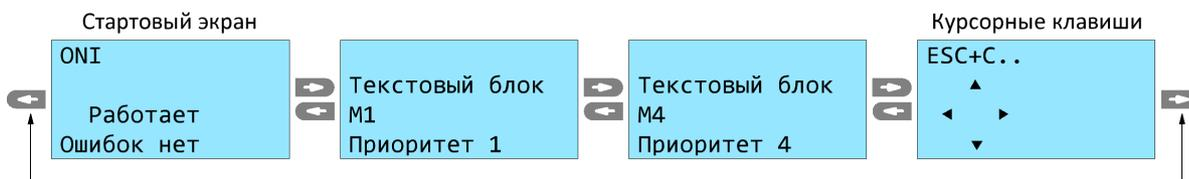
При поступлении сигнала на вход I001, независимо от того, какой экран отображается в данный момент, будет выведен блок M2. При пропадании сигнала I001, отобразится последний экран, который отображался до срабатывания входа I001. Если входной сигнал I001 присутствует постоянно, то пользователь также сможет переключаться между блоками M1, M4 клавишами "вправо/влево", но при нажатии "вверх/вниз", отобразится M2:
