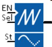
Блок реализует функцию генератора линейно нарастающего и спадающего сигнала с возможностью формирования промежуточного постоянного уровня на нарастающем фронте.
