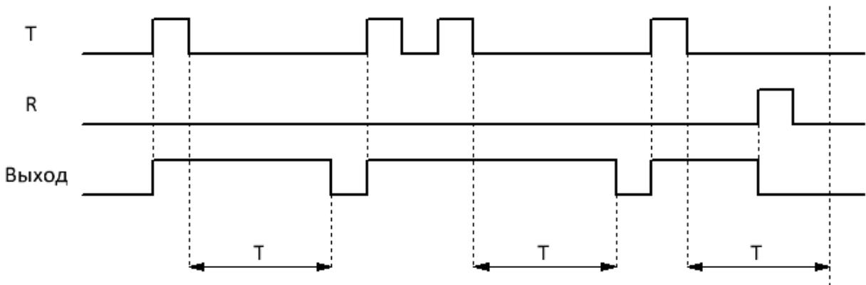
Уставка задержки выключения (T) задается на вкладке "параметры" в окне свойств блока, и может быть определена как постоянная, или как переменная величина.
