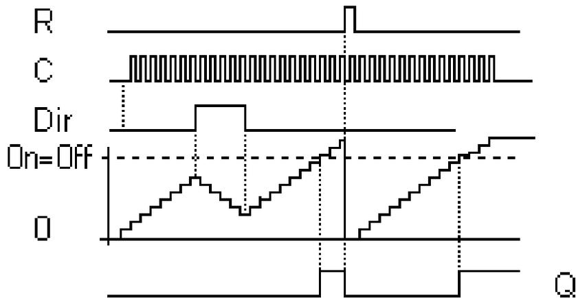
Начальное и пороговые значения устанавливаются на вкладке "параметры" в окне свойств блока, и могут быть определены как постоянные, или как переменные величины.
