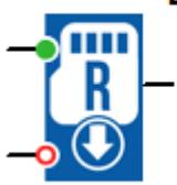
При изменении состояния входа Т из логического нуля в состояние логической единицы блоком будет выполнено чтение данных с карты карту памяти в соответствии с настройками. В случае удачного окончания процесса чтения выход блока будет установлен в состояние логической единицы.
