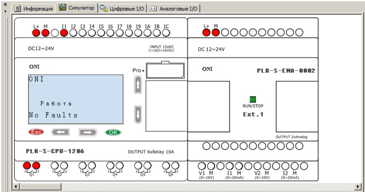
Вкладка "Цифровые IO" отображает цифровые входы и выходы, задействованные в проекте и позволяет имитировать входные воздействия при отладке программы в симуляторе.
