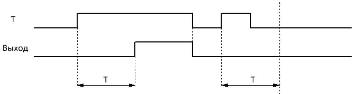
Уставка задержки включения (Т) задается на вкладке "параметры" в окне свойств блока, и может быть определена как постоянная, или как переменная величина.
