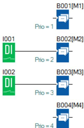
В данном случае, при отсутствии сигналов на входах I001, I002, на стартовом экране пользователь сможет переключаться клавишами "вправо/влево" между блоками M1 и M4:
