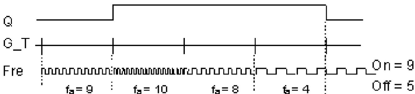
Пороговые значения и длительность временного интервала измерения задаются на вкладке "параметры" в окне свойств блока. При этом длительность интервала измерения может быть определена, как переменная величина.
