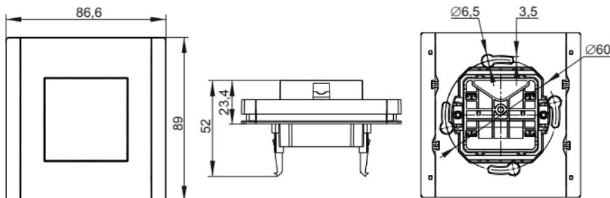
Габаритные и установочные размеры заглушки / Overall and installation dimensions of the plug / Бітеменің габариттік және орнату өлшемдері / Dimensiunile generale și de instalare ale fișei / Залгуурын овор ба суурилуулах хэмжээ / Zaglushkaning gabaritlari bo'yicha va o'rnatish natijasidagi o'lchamlari
