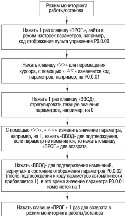
Рисунок 24 – Настройка параметров с помощью пульта управления
