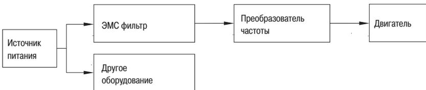
Рисунок 12 – Подключение фильтра со стороны входа
