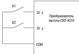
Рисунок 50 – Двухпроводной способ управления 2
