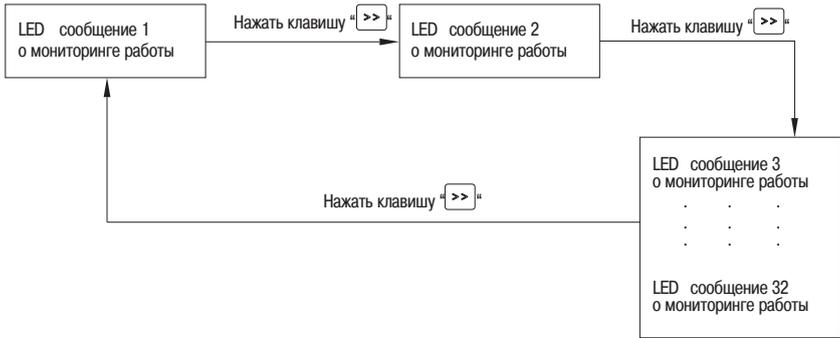
Рисунок 23 — Просмотр состояния преобразователя в остановленном состоянии
