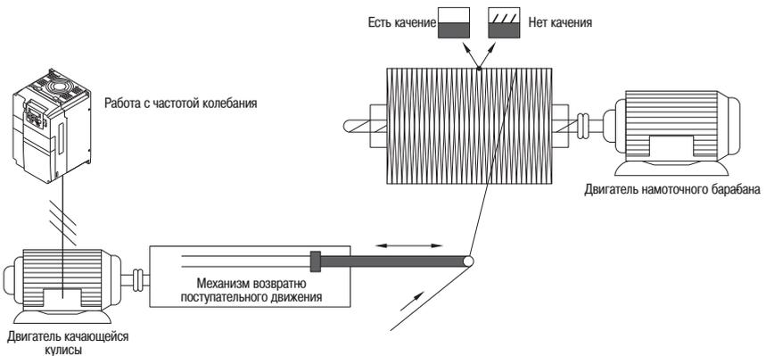
Рисунок 75 — Пример оборудования для использования частоты колебания
