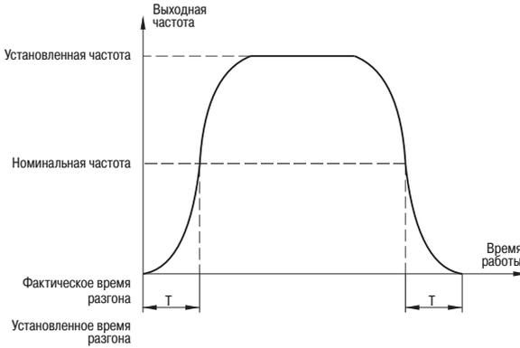
Рисунок 27 — S кривая ускорения и замедления
