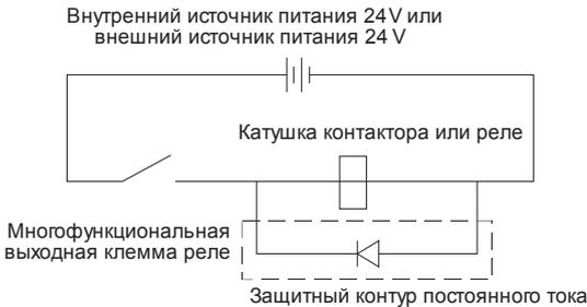
Рисунок 18 – Схема подключения выходного реле на постоянный ток
