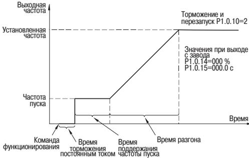
Рисунок 55 — Пуск с торможением постоянным током
