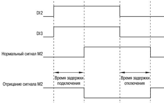
Рисунок 70 – Временная диаграмма работы внутреннего реле
