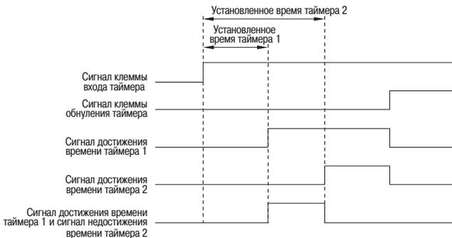
Рисунок 72 — Обнуление таймеров
