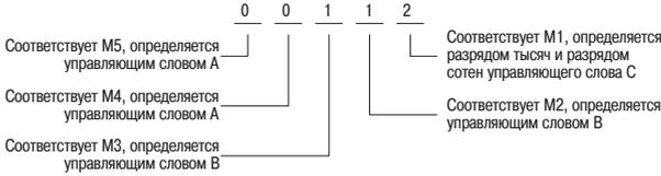
Рисунок 66 – Пример 1 структуры управляющего слова промежуточных реле
