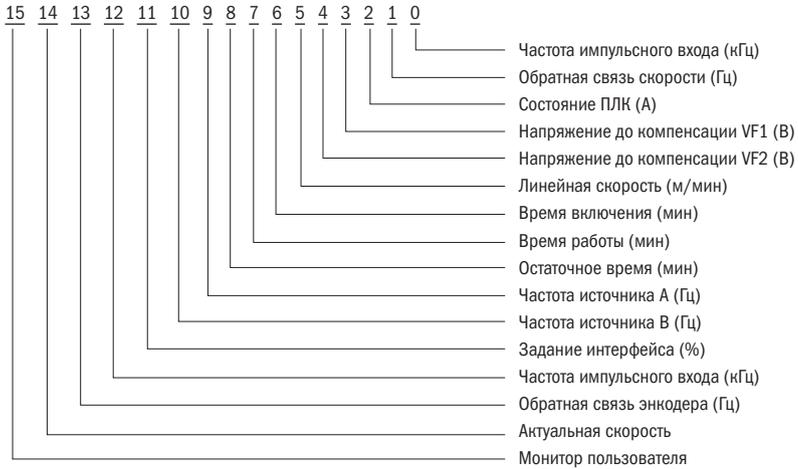
Рисунок 44 – Отображение 2 LED при работе
