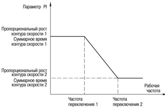
Рисунок 31 – Частоты переключения
