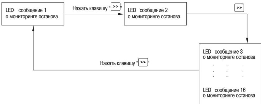
Рисунок 22 – Алгоритм просмотра состояния преобразователя частоты
