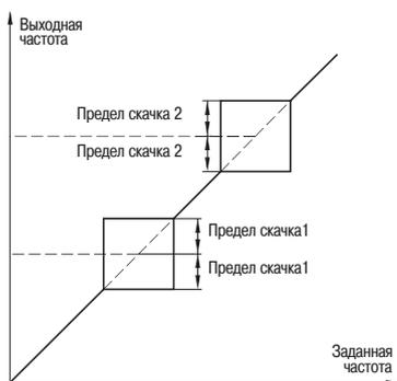
Рисунок 29 – Скачкообразные частоты
