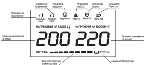
Рисунок 3. Индикация режимов работы на дисплее стабилизатора.
