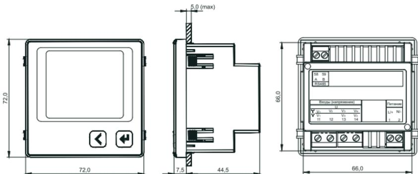
Рисунок 1 — Габаритные размеры вольтметра
