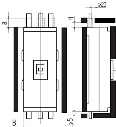
Выключатель стационарного исполнения с электромагнитным приводом
