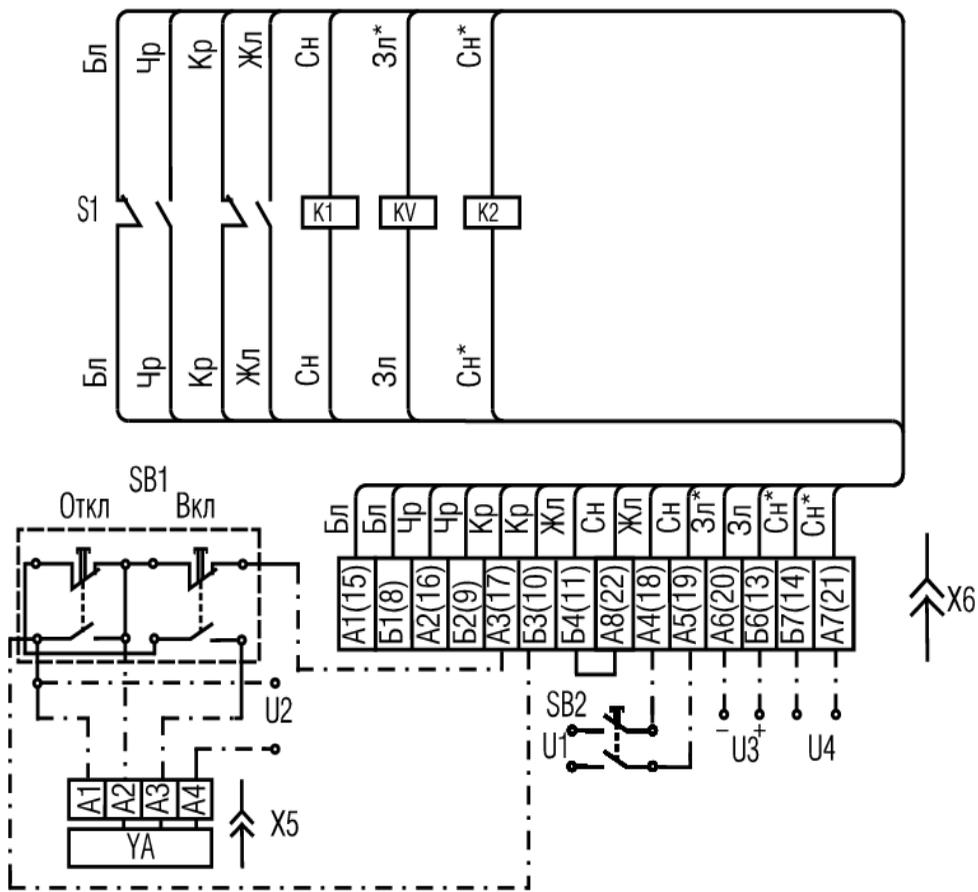
Примечание – независимый расцепитель K2 может устанавливаться в выключатели АЗ791Б, АЗ792Б
