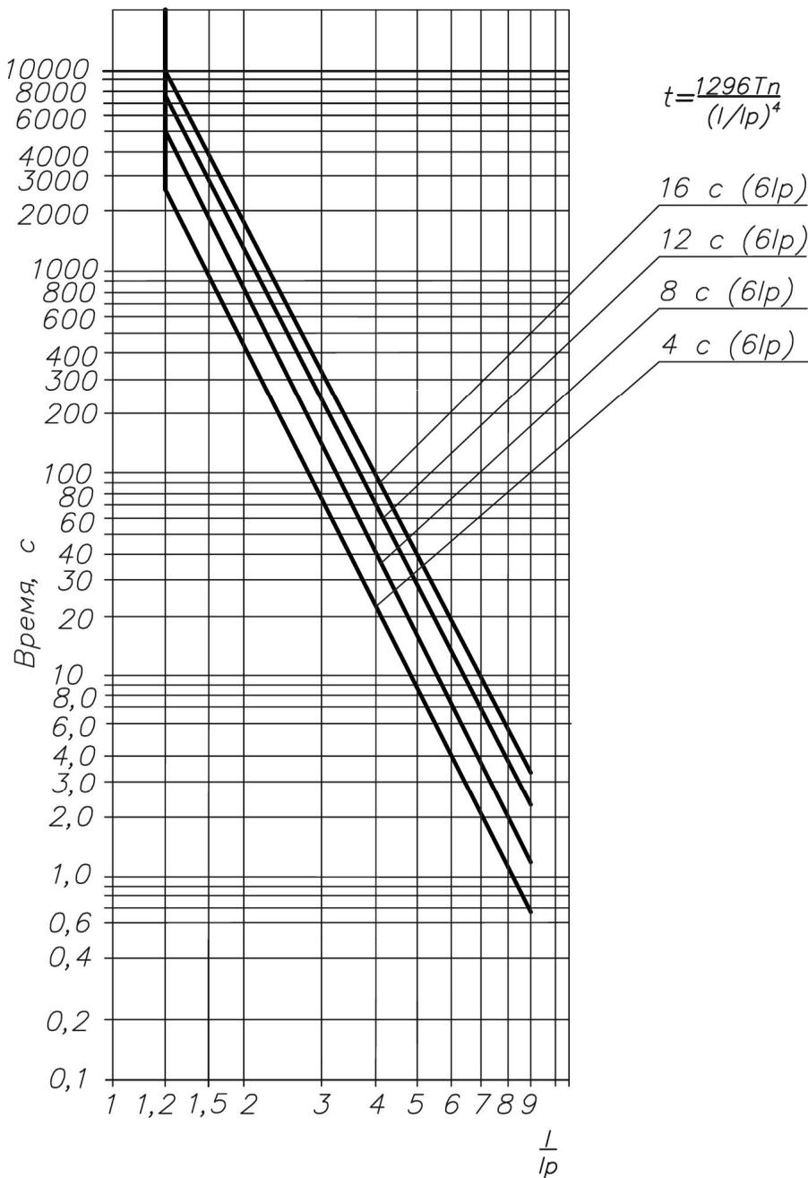
Рисунок Б.2 - Времятоковая характеристика защиты от перегрузки, обратная 4 степени
