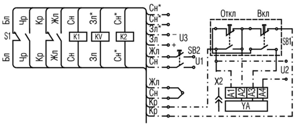
Примечание – независимый расцепитель K2 может устанавливаться в выключатели А3791Б, А3792Б
