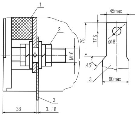
Допускается установка кабельных наконечников по ГОСТ 7386-80 с диаметром отверстия под жилу от 17 до 23 мм. Кабельные наконечники под пайку, поставляемые по отдельному заказу, с диаметром отверстия под жилу 8; 9; 10,5; 12; 14; 26 мм.
