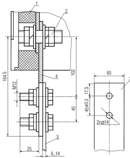
1 - выключатель; 2 - зажим; 3 - присоединяемая шина; 4 - переходная шина
