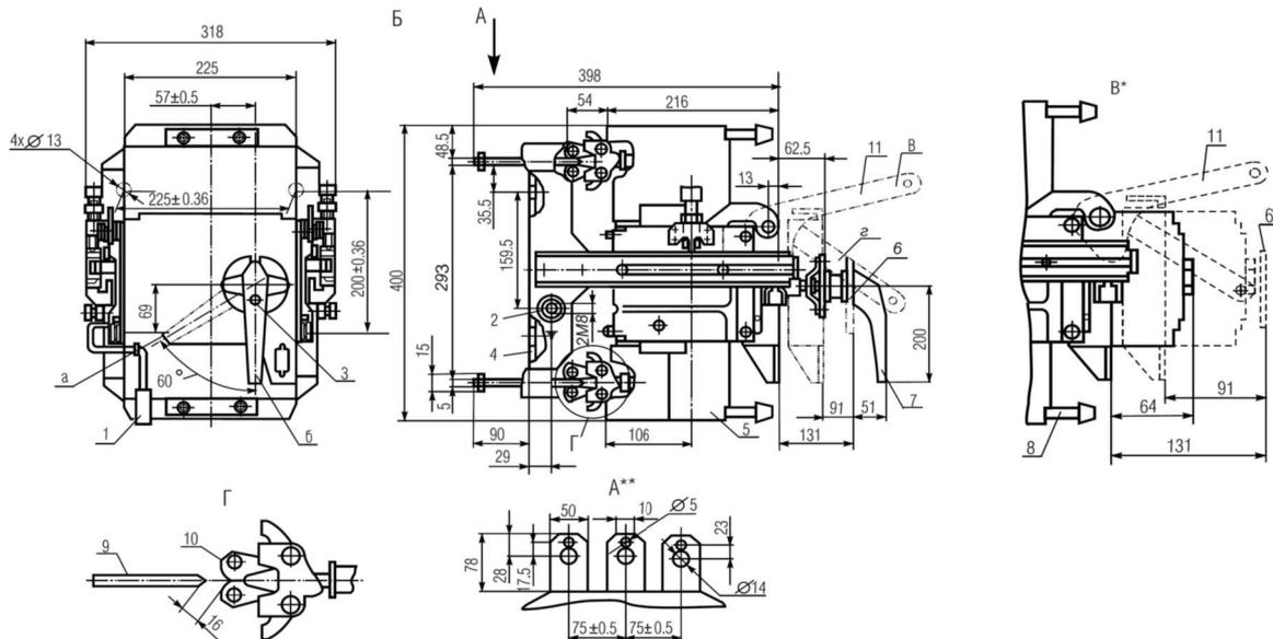
Б - исполнение 1. Выключатель с механической блокировкой и ручным дистанционным приводом; В - исполнение 2.
