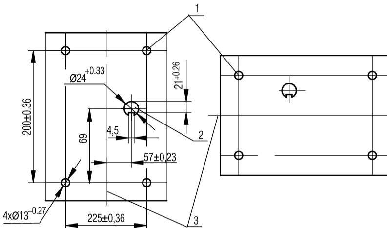
1 - отверстия для крепления панели; 2 - отверстие на двери для установки ручного дистанционного привода; 3 - вертикальная ось выключателя
