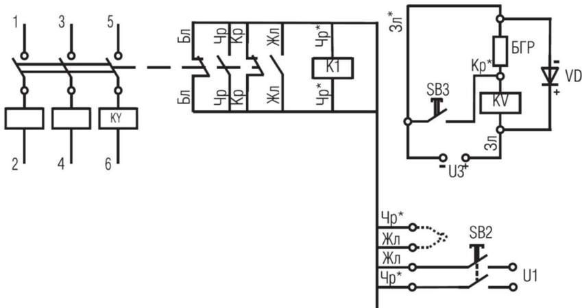
SB3 - выключатель кнопочный для форсировки KV постоянного тока при включении выключателя
