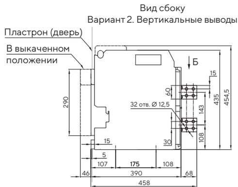
Расположение крепежных отверстий (вид снизу)
