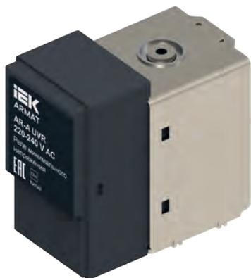
Модуль временной задержки расцепителя минимального напряжения обычно настраивается на 0,5 с, 1 с, 2 с, 3 с (заводская уставка по умолчанию 3 с) или более. Модуль с временной задержкой от 3 с до 9 с согласовывается с заводом-изготовителем индивидуально. Точность задержки при 0,5 с составляет  $\pm 30\%$ , при 1 с, 2 с, 3 с и более составляет  $\pm 10\%$ .
