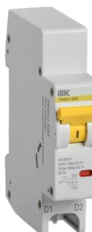
**Расцепители минимального/максимального напряжения PMM47-60M IEK®** отключают одно-, двух- или трехполюсные автоматические выключатели серии ВА47-60M IEK® при недопустимом снижении или повышении напряжения сети.
