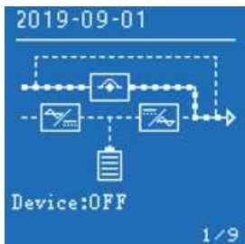
Рисунок 46 – Режим ECO или статический байпас
