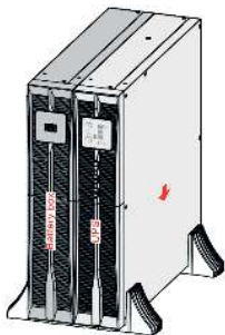
Рисунок 24 – Установка ИБП и бока АКБ на один комплект опор
