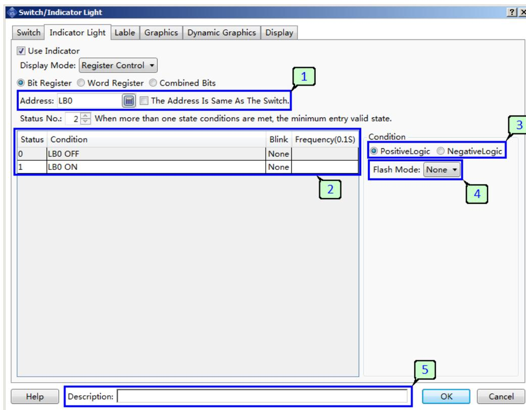
1. Адрес регистра, состояние которого будет отображать индикатор. В случае если данный элемент также используется в качестве клавиши и функция индикатора необходима для отображения ее состояния, можно активировать опцию "Использовать адрес клавиши", значение адреса будет автоматически скопировано.
