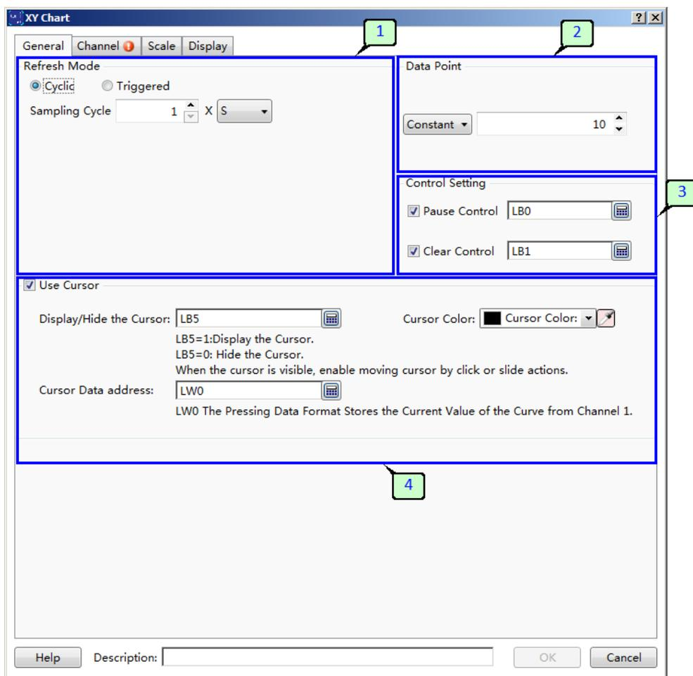
К основным настройкам графика относится выбор способа обновления графика [1]. Можно выбрать циклический способ обновления и указать временной интервал, либо обновление по событию и указать адрес регистра, изменение состояние которого будет служить условием для обновления данных. Также к основным настройкам относится количество точек данных выводимых на экран [2], а также регистры управления процессом вывода данных: пауза и очистка [3].
