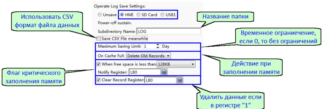
Для вариантов хранилища SD Card или USB, панель должна поддерживать работу с данным носителем, и он должен быть установлен в соответствующий слот. В противном случае будет сформировано сообщение об ошибке.
