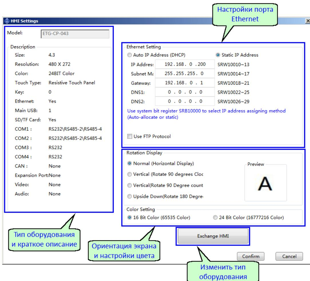
При необходимости переноса проекта с одного типа панели на другой, можно воспользоваться функцией "Сменить тип HMI". Щелкните левой клавишей мыши по кнопке, расположенной в нижней части экрана и в появившемся окне выберите новый тип панели из выпадающего списка.
