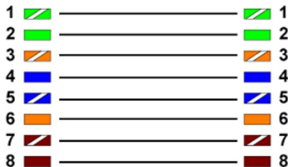
Кросс-кабель для непосредственного подключения к ПЛК\*
