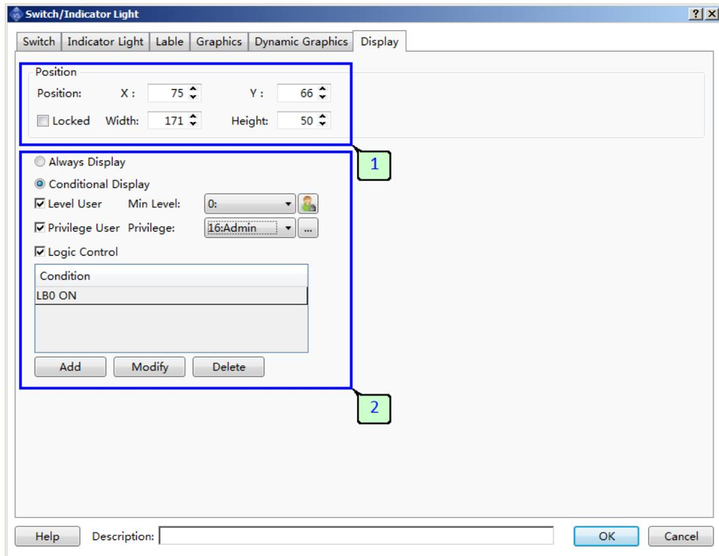
1. Позиция и размер элемента в пикселах. Отсчет позиции ведется от верхнего левого угла экрана. Опция "Заблокировано" позволяет запретить изменение размера и положения элемента с помощью указателя мыши в редакторе окон.
