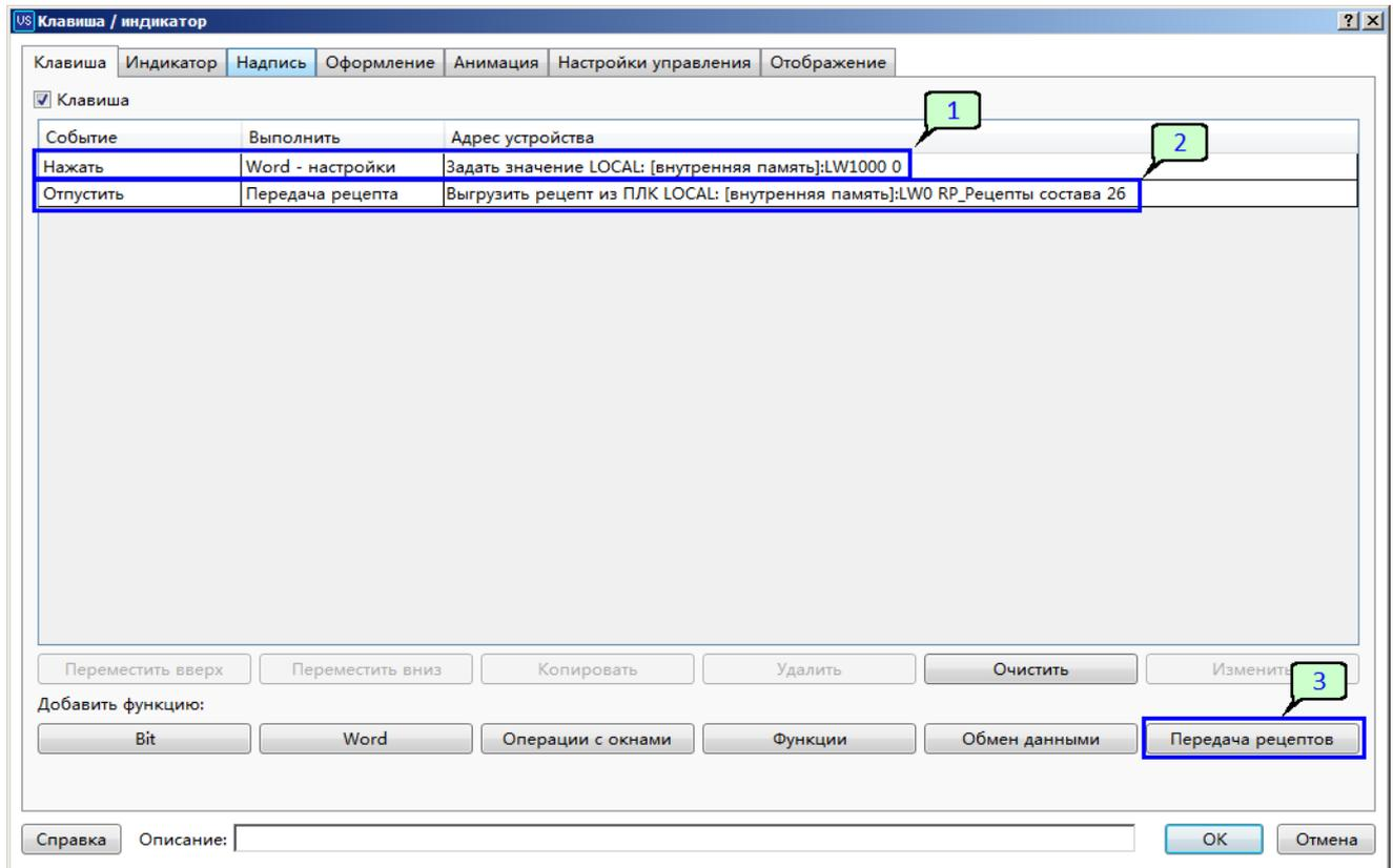
В диалоговом окне функции передачи рецептов мы выбираем направление передачи "в ПЛК" [1] или "из ПЛК" [2]. Первое направление используется для сохранения рецепта в массиве, второе для загрузки рецепта в память панели, которая в примере выступает в роли ПЛК. Также обязательно необходимо выбрать файл рецептов с которым мы работаем [4] и стартовый адрес в памяти ПЛК [3] начиная с которого будет производиться выгрузка или загрузка данных.
