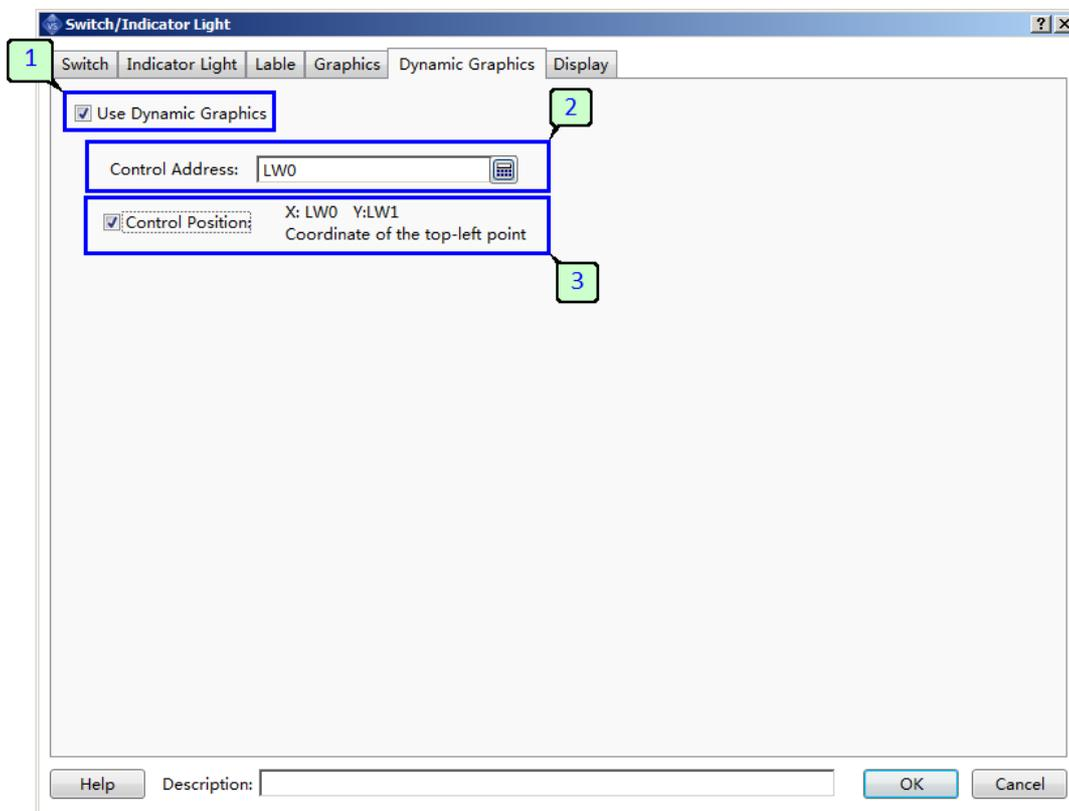
2. Выберите адрес регистра (стартовый адрес регистров) значение в котором, будет определять положение элемента.
