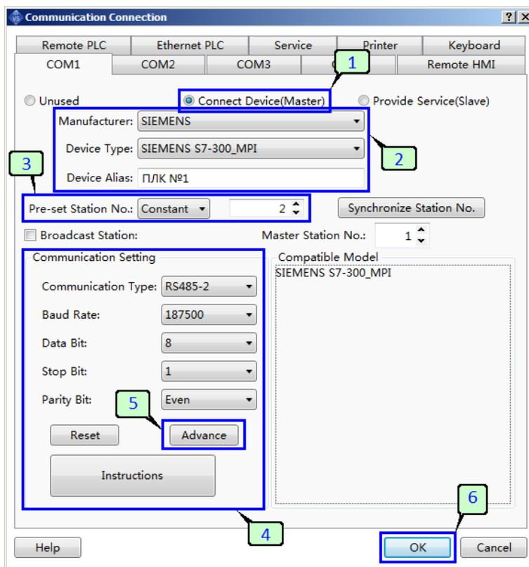
2. Из выпадающего списка выберите изготовителя и тип подключаемого оборудования, а также укажите имя для идентификации ПЛК в проекте.
