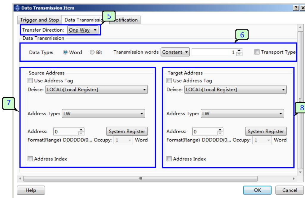
5. Передача данных может быть выполнена как в одностороннем режиме, так и в обоих направ-лениях между источником и местом назначения.
