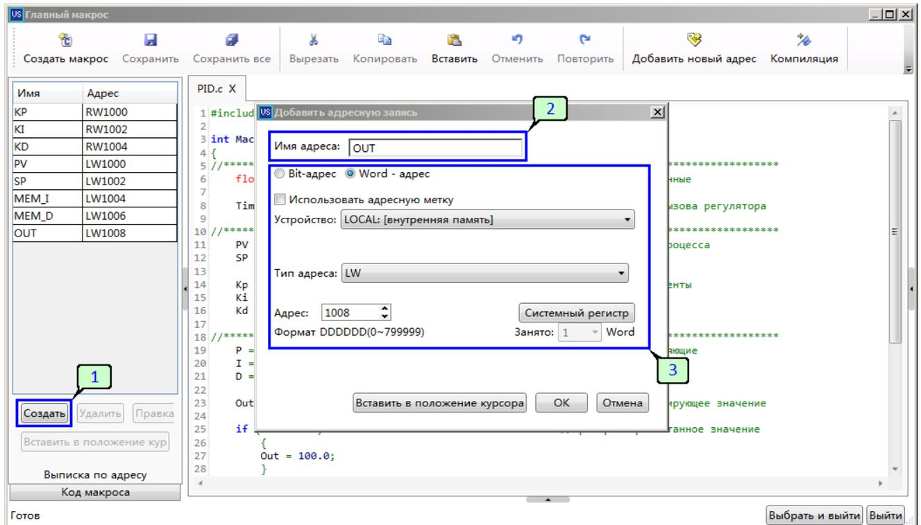
В общем случае в теле макроса можно выделить три основных раздела: чтение данных из памяти панели оператора, выполнение вычислений с загруженными данными и запись результата обратно в память панели оператора.
