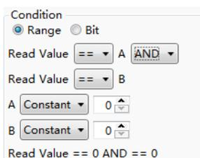
Или проверить состояние определенного бита в регистре по его номеру. Во втором случае, можно также выбрать режим прямой или инвертированной индикации. В случае последней статус будет активен если указанный бит находится в состоянии логического нуля.
