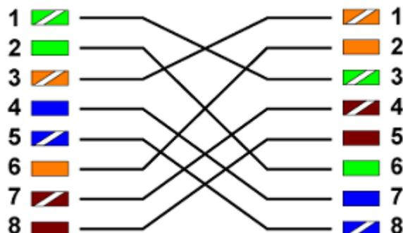
\* В случае если ПЛК поддерживает функцию автоопределения типа подключения, можно использовать прямой кабель.
