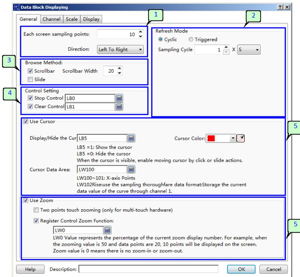
На данной вкладке определяется количество точек отображаемых на экране и направление построения графика (горизонтальное или вертикальное) [1]. В случае если объем данных превышает заданный размер видимой области, то для навигации может использоваться полоса прокрутки или листание жестом [3].
