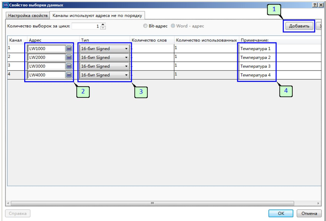
Закончив настройку сбора данных нажимаем "Ок" и переходим к редактированию графической части проекта. Для отображения данных мы будем использовать графический формат и компонент "Временной тренд". Выбираем его в меню "Компоненты > Графики и диаграммы" и добавляем в проект.
