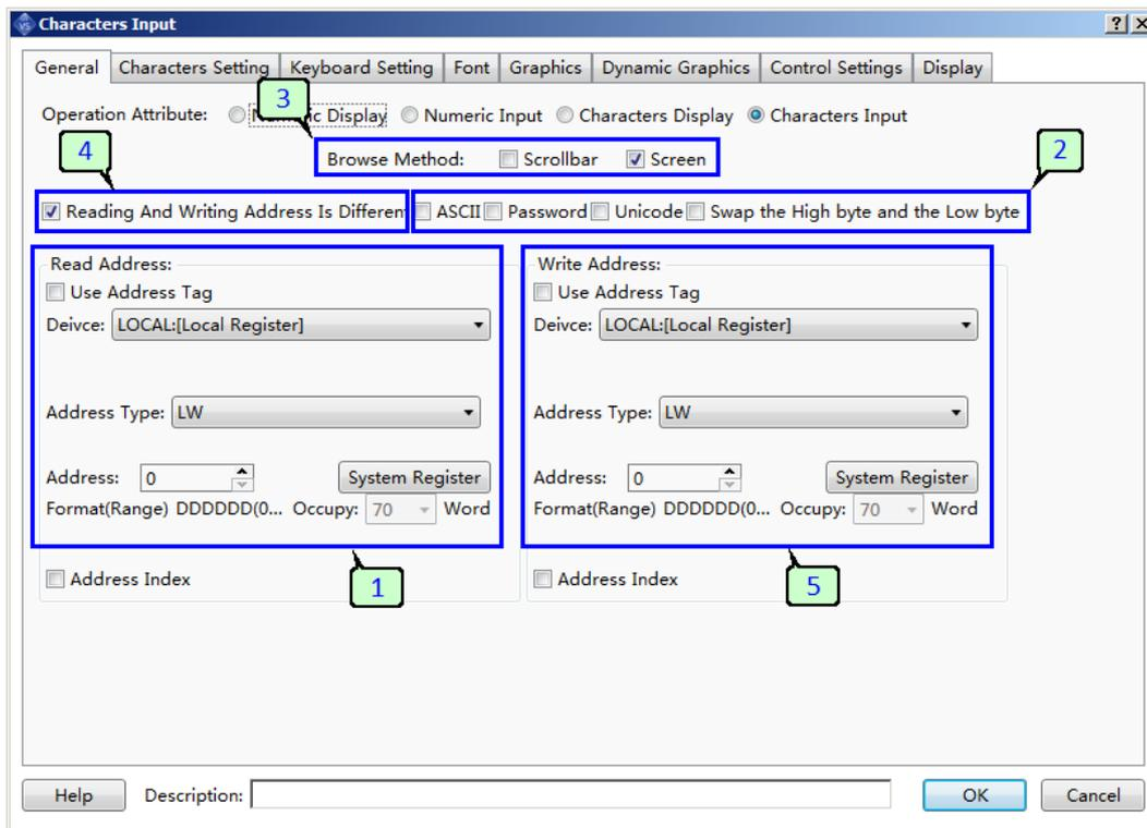
1. Поле ввода начального адреса регистров памяти, значения в которых будут отображаться дисплеем. Количество регистров необходимых для размещения данных зависит от используемой кодировки символов и организации памяти. Например, при использовании внутренней памяти панели для размещения 10 символов в кодировке ASCII понадобится 5 регистров LW0-LW4.
