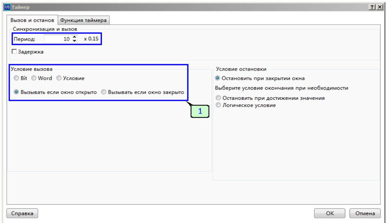
В примере выше условием запуска таймера является условие открытия окна. Иными словами таймер будет работать все время пока окно открыто, соответствующим образом будет себя вести и макрос. Если необходимо иное условие работы таймера и макроса, то его можно настроить здесь же [1].
