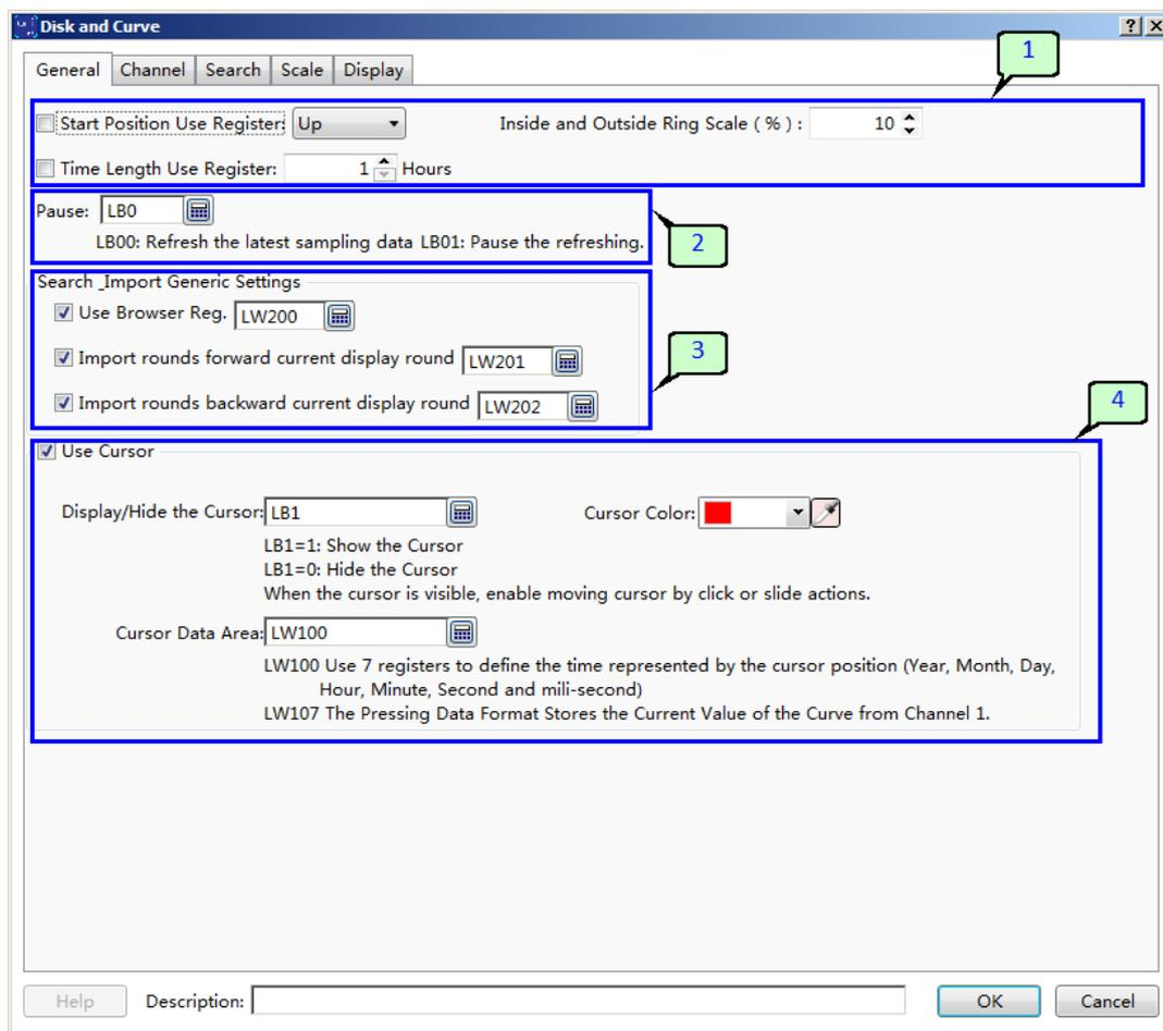
Поле [1] позволяет выбрать начальную точку и емкость графика в диапазоне от 1 до 24 часов, а также задать соотношение внешнего и внутреннего радиусов рабочего поля. Указанные выше настройки могут быть как статическими, заданными однажды при настройке проекта, так и меняться в процессе работы. Во втором случае необходимо установить галочки и выбрать регистры значения в которых будут определяющими.
