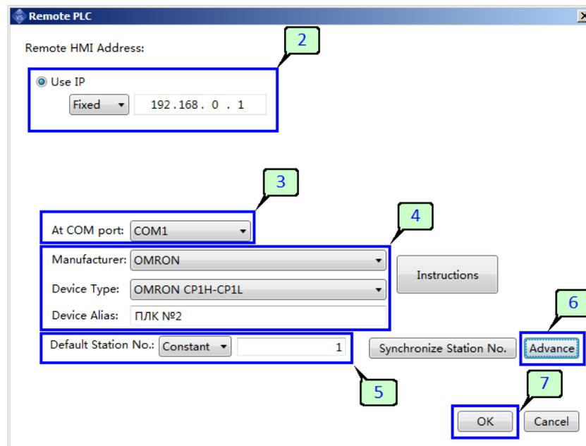
3. Выберите COM порт удаленной панели к которому подключен удаленный контроллер.
