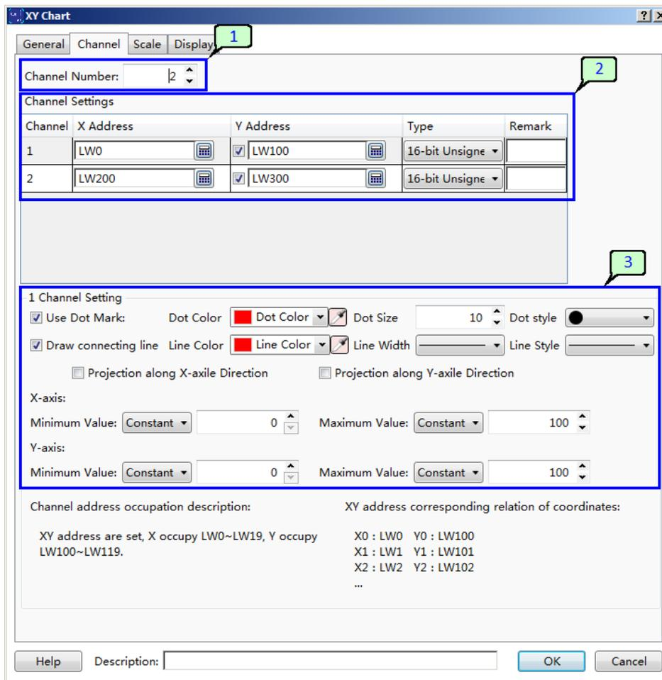
В настройках задается количество каналов выводимых на экран [1], а также стартовые адреса регистров хранения значений и тип данных [2]. При этом адреса регистров данных оси Y могут быть указаны независимо или назначены автоматически, в первом случае данные в памяти располагаются по порядку начиная с указанного адреса.
