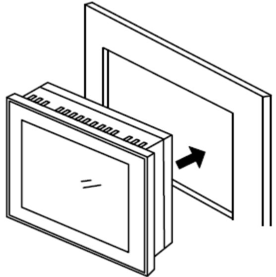
Вставьте металлические трубки-фиксаторы из монтажного комплекта в отверстия на корпусе устройства и затяжкой винтов зафиксируйте фиксаторы и монтируемое устройство.
