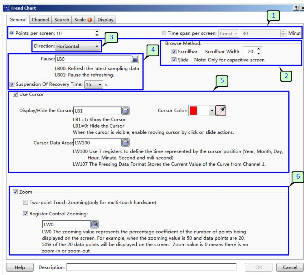
К основным настройкам графика относится выбор типа отсчета и объем выводимой информации по временной оси [1]. Можно указать количество точек данных или задать временной интервал, который будет выведен в видимой области графика. В случае если объем данных превышает заданный размер видимой области, то для навигации [2] может использоваться полоса прокрутки или листание жестом.
