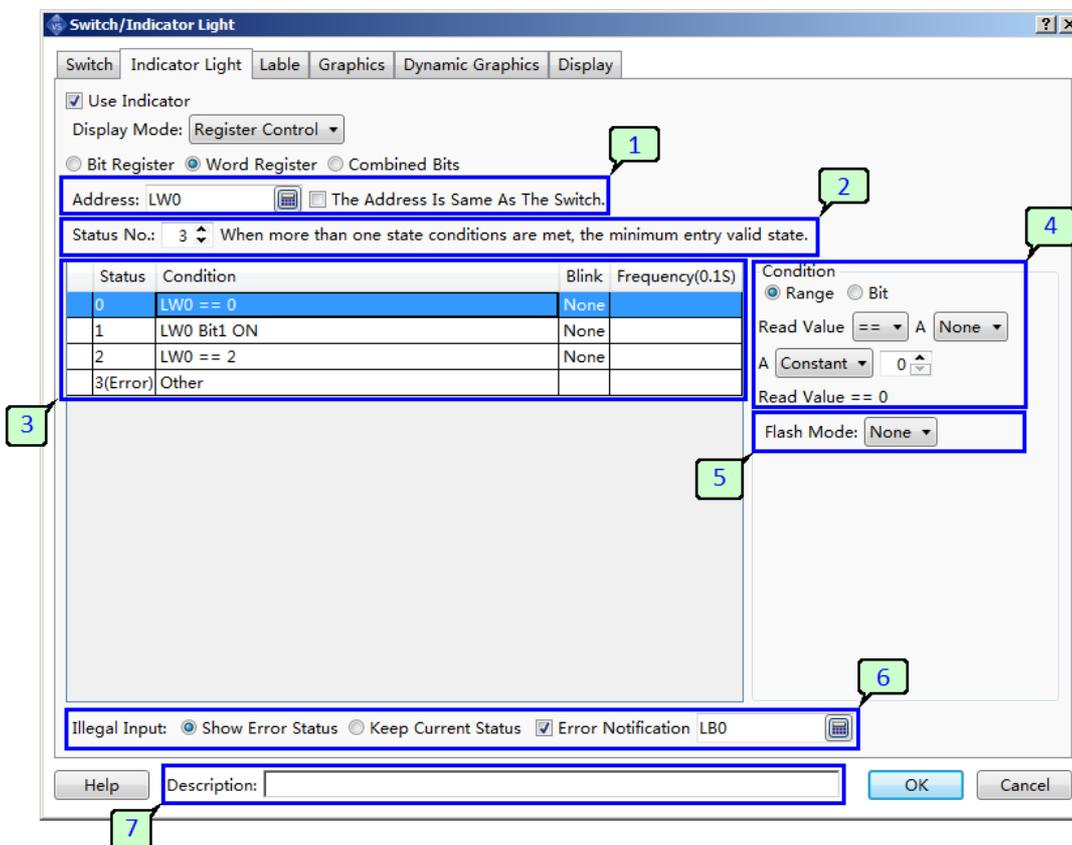
1. Адрес регистра, состояние которого будет отображать индикатор. В случае если данный элемент также используется в качестве клавиши и функция индикатора необходима для отображения его состояния, можно активировать опцию "Использовать адрес клавиши", значение адреса будет автоматически скопировано.
