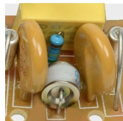
Два вариостора обеспечивают защиту от импульсных перенапряжений.
