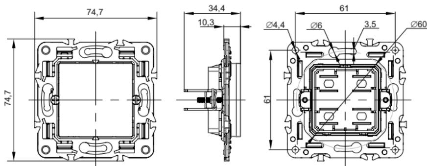
Габаритные и установочные размеры вывода кабеля / Overall and installation dimensions of the cable outlet / Кабель шықпасының габариттік және орнату өлшемдері / Dimensiunile generale și de instalare ale ieșirii cablului
