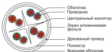
Рисунок 4 – Конструкция патч-кабеля категории 6 типа F/UTP
