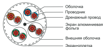
Рисунок 6 – Конструкция патч-кабеля категории 6A типа S/FTP
