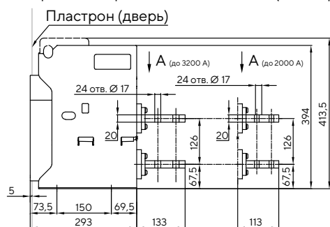
Вид сбоку Вариант 1. Горизонтальные выводы (стандарт)
