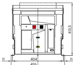
Расположение крепежных отверстий (вид снизу)
