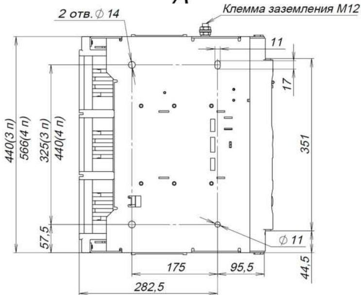
Рисунок А.4 - Выключатель Протон М 40 выдвигного исполнения (лист 1 из 8)
