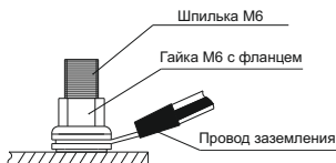
Рисунок 11 – Монтаж заземления к шпильке
