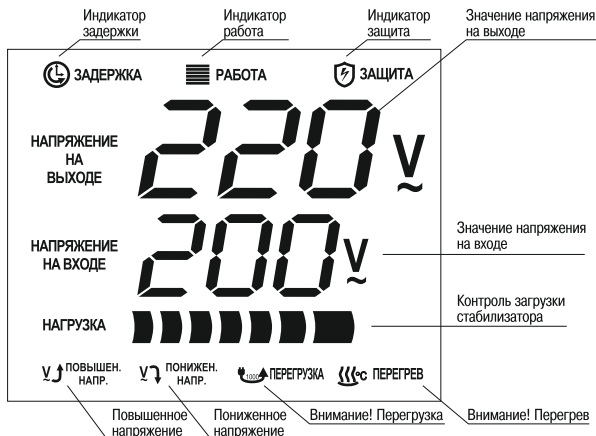
Рисунок 2. Индикация режимов работы стабилизаторов
