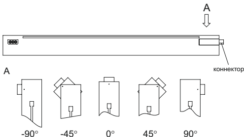
Рисунок 4 – Примеры положений вращающегося блока подключения
