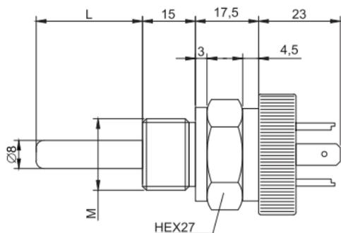
а) преобразователь погружной с присоединением DIN43650 (PTS-X-X-X-2-X-X)
