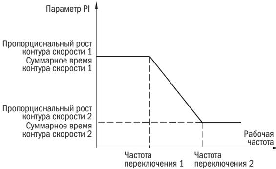
Рисунок 30 – Частоты переключения
