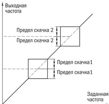
Рисунок 28 – Скачкообразные частоты
