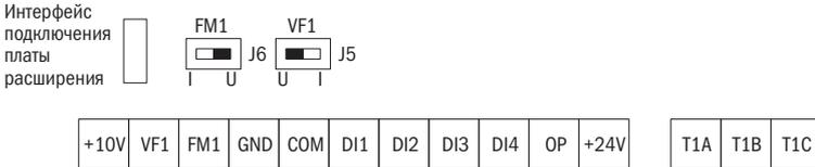
Рисунок 12 – Клеммная колодка платы управления преобразователя
