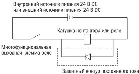
Рисунок 17 – Схема подключения выходного реле на постоянный ток
