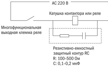
Рисунок 16 – Подключение выходного реле на переменный ток
