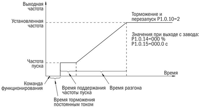
Рисунок 54 – Пуск с торможением постоянным током
