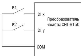
Рисунок 49 – Двухпроводной способ управления 2
