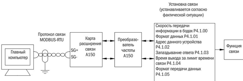
Рисунок 64 – Соединение по интерфейсу с внешним PLC
