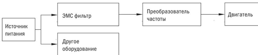
Рисунок 11 – Подключение фильтра со стороны входа
