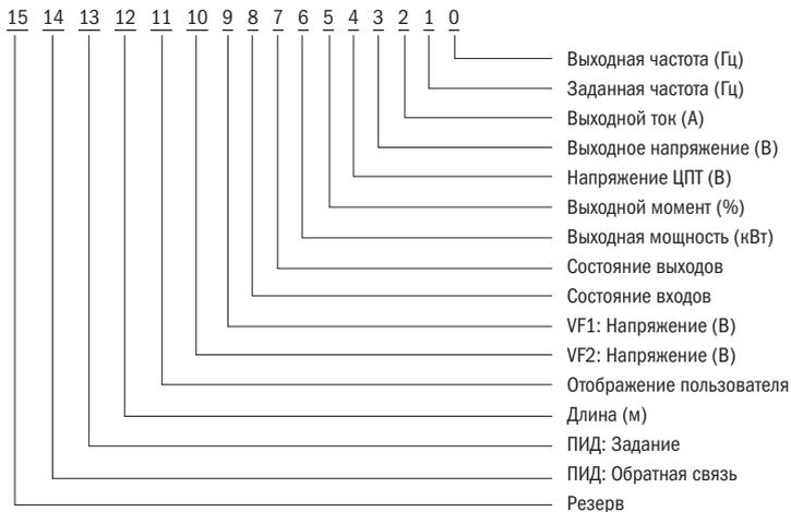
Рисунок 42 – Отображение 1 LED при работе
