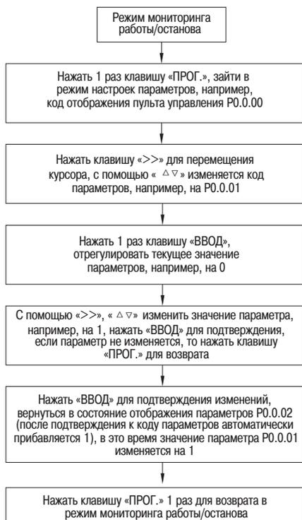
Рисунок 23 – Настройка параметров с помощью пульта управления
