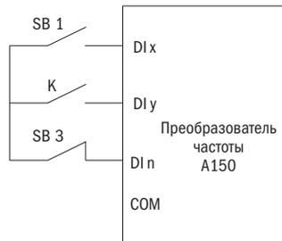
Рисунок 51 – Трехпроводной способ управления 2
