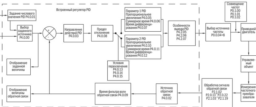
Рисунок 59 – Структура ПИД-регулятора
