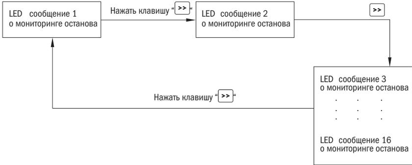
Рисунок 21 – Алгоритм просмотра состояния преобразователя частоты
