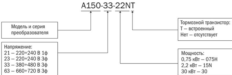
Рисунок 1 – Пример расшифровки артикула преобразователя частоты
