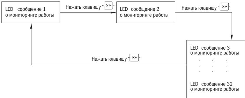
Рисунок 22 – Просмотр состояния преобразователя в остановленном состоянии
