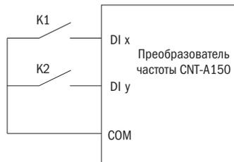
Рисунок 48 – Двухпроводной способ управления 1
