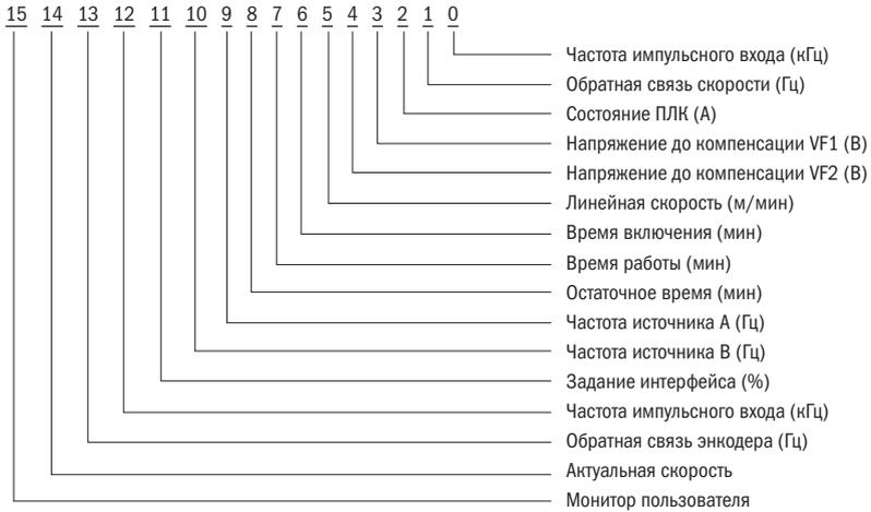
Рисунок 43 – Отображение 2 LED при работе
