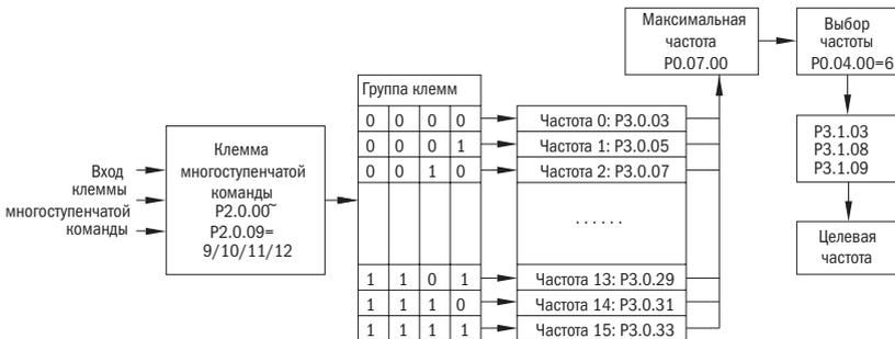
Рисунок 57 – Выбор многоступенчатой скорости
