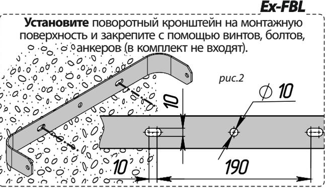
**Установите и закрепите светильник на поворотный кронштейн. Выберите необходимый угол наклона и зафиксируйте светильник.**
