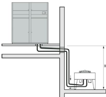
3.5.1.2 Жидкостный трубопровод должен быть защищен от солнечной радиации.
