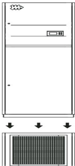
Модуль с решетками устанавливается внизу в случае, если воздух подается непосредственно в помещение, расположенное под кондиционером. Только для моделей с нижним выбросом воздуха.
