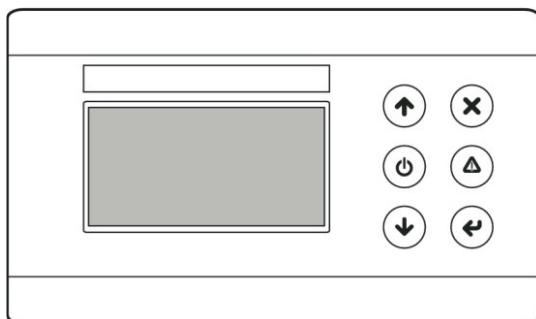
Выполняет те же функции, что и панель, установленная на кондиционере.
