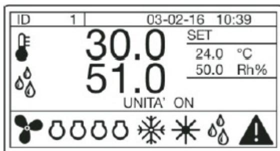
На дисплее отображается информация, отражающая состояние кондиционера: температура уставки, температура окружающей среды, уставка влажности, влажность окружающего воздуха, режим работы, время, дата.
