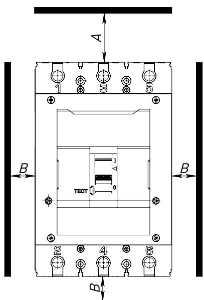
**Минимальные расстояния от выключателя до заземленных металлических частей распределительства, а также до изоляционных щитов**
