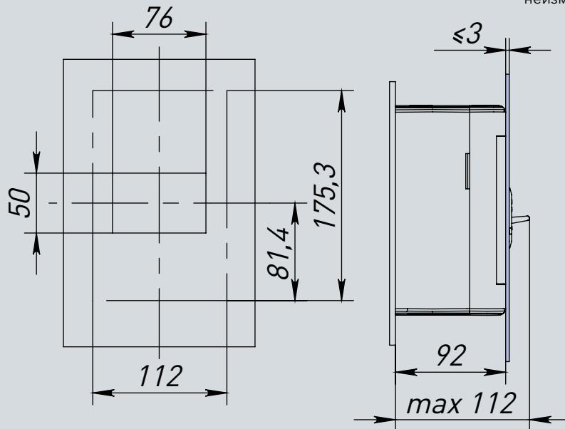
Автоматические выключатели устанавливаются в любом положении (горизонтальном, вертикальном на вертикальной плоскости и на горизонтальной плоскости (рукойткой вверх). При этом их рабочие характеристики остаются неизменными.
