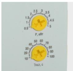
На лицевой панели – регуляторы ограничения мощности и времени включения нагрузки.
