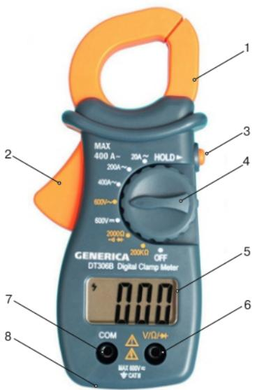
1 – Клещи-трансформатор. Служат для бесконтактного измерения переменного тока, протекающего по проводнику.
