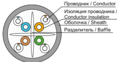
**Конструкция кабеля типа F/UTP
