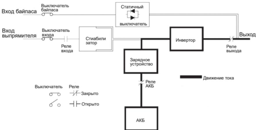
Рисунок 13 – Схема работы ИБП в режиме АКБ
