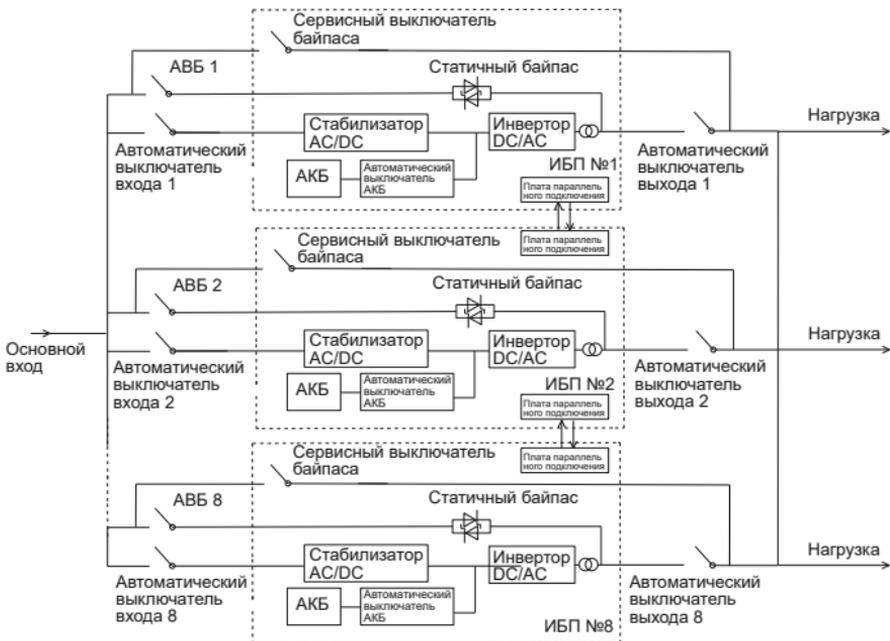
Рисунок 35 – Схема параллельного подключения ИБП с одним входом
