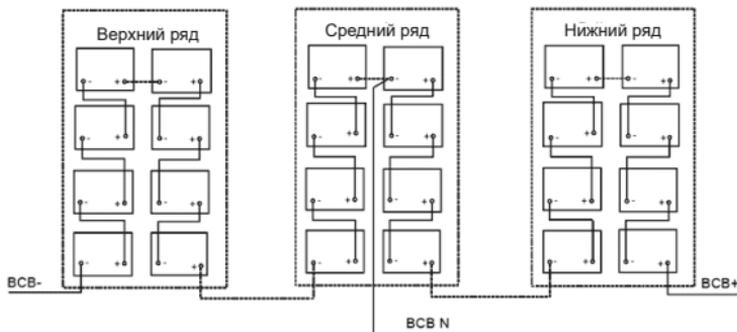
Рисунок 33 – Схема подключения АКБ
