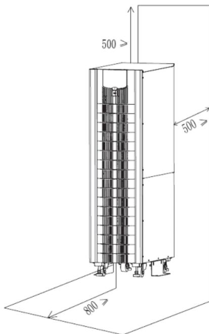
Рисунок 5 – Пример установки ИБП
