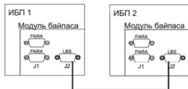
Рисунок 37– Подключение LBS портов
