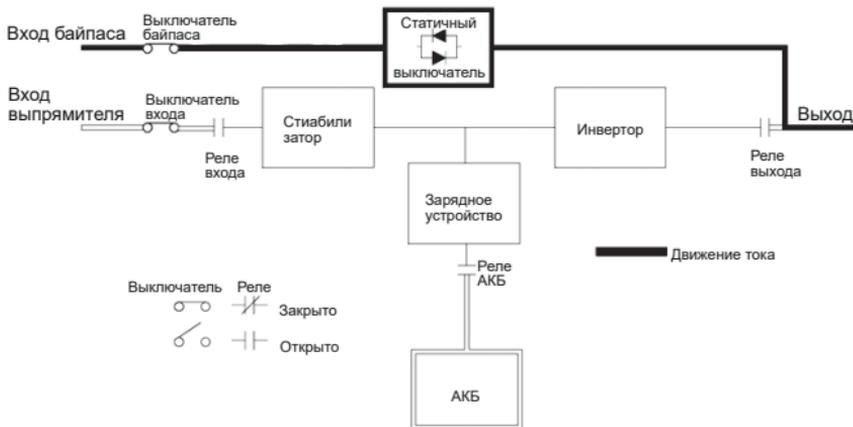
Рисунок 12 – Схема работы ИБП в режиме байпаса
