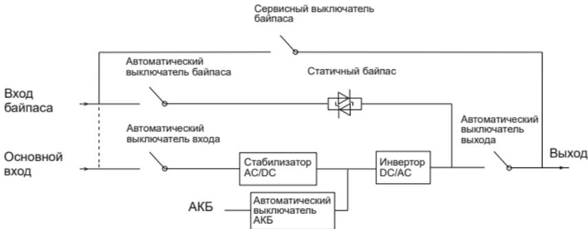
Рисунок 10 – Структура ИБП
