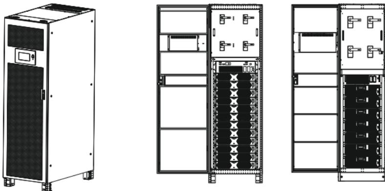
Рисунок 2 – Внешний вид системного шасси типа EOM-F-0200kVA
