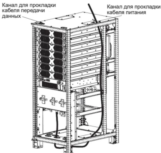
Рисунок 16 – Прокладка кабеля для модели 125 кВА
