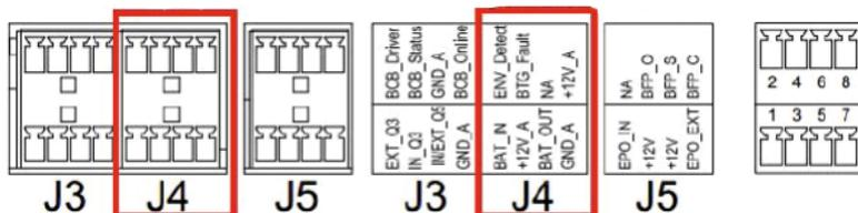
Рисунок 21 – Сухие контакты аварийных оповещений
