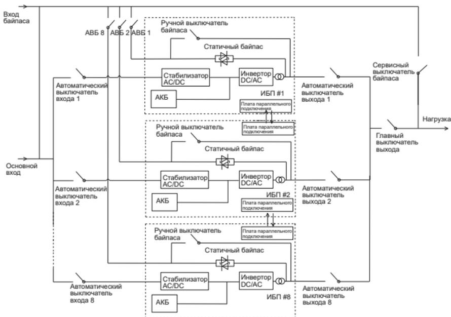
Рисунок 34 – Схема параллельного подключения ИБП с двойным входом
