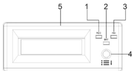
Рисунок 25 – Панель управления силового модуля ИБП 125–200 кВА
