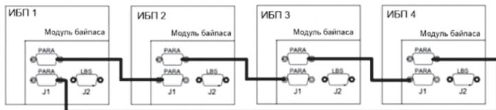
Рисунок 36 – Схема подключения соединительного кабеля плат параллельного подключения
