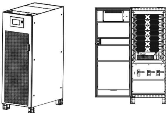
Рисунок 1 – Внешний вид системного шасси типа EOM-F-0125KVA
