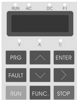
Рисунок 7 – Кнопочная панель управления
