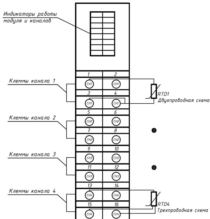
Рисунок 12 - Внешний вид модуля PLC-250-EMT-04R00-0DC
