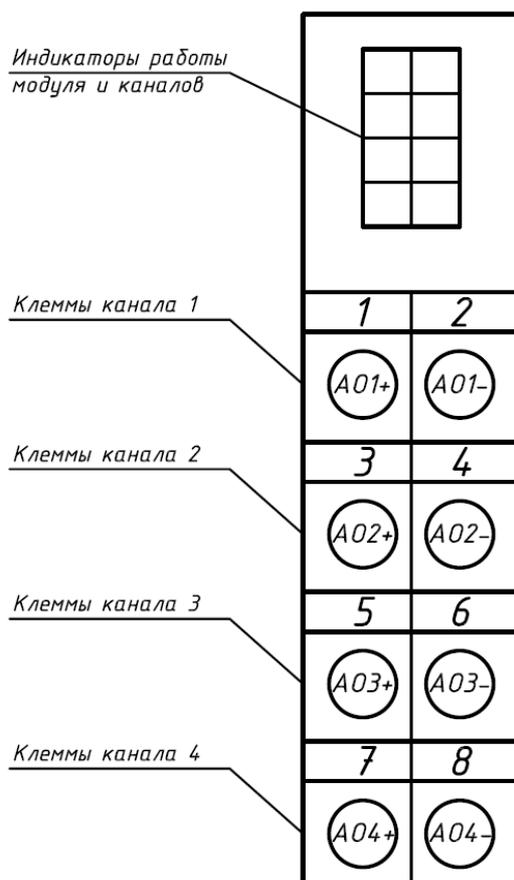
Рисунок 3 - Внешний вид модуля PLC-250-EMA-0004V-0DC
