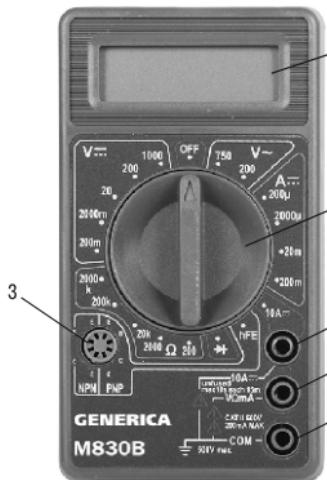
1 – LCD-дисплей 3 ½ разряда, высота знаков 12,7 мм. Дисплей отображает в цифровом виде результат измерения.
