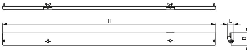
Внешний вид и габаритные размеры панели модуля крыши / Appearance and overall dimensions of the roof module panel / Төбе модулінің сыртқы көрінісі мен габариттік өлшемдері крыши
