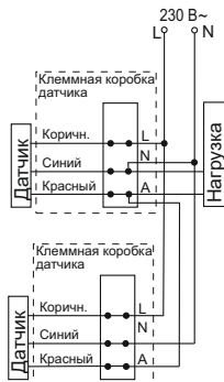
Рисунок 5 - Схема параллельного подключения датчиков
