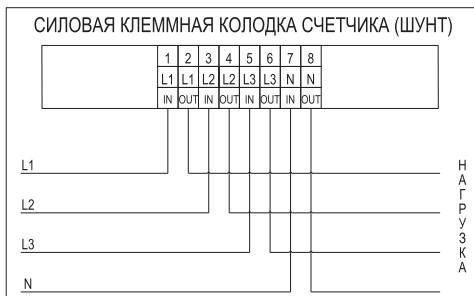
Рисунок 8 – Схема подключения счетчика к сети электроснабжения напрямую
