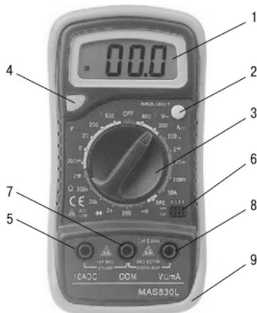
Рисунок 1 – Элементы лицевой панели мультиметров
