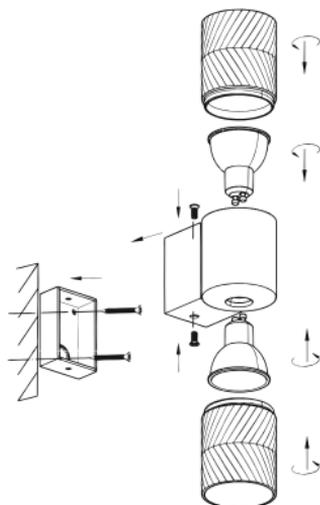
Рисунок 1 – Схема монтажа светильников типа 5220, 5221, 5198, 5199
