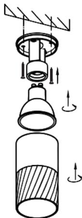
Рисунок 2 – Схема монтажа светильников типа 5222
