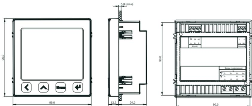
Рисунок 1 – Габаритные размеры вольтметра
