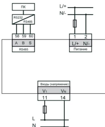
Рисунок 2 – Типовая схема присоединения однофазного вольтметра
