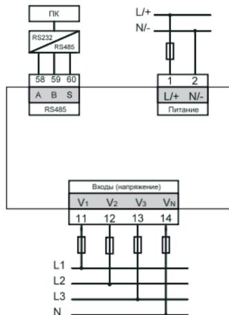
Рисунок 3 – Типовая схема присоединения трехфазного вольтметра
