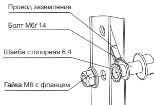
Рисунок 14 – Монтаж заземления к стойке
