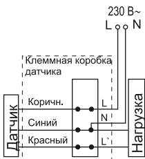
Рисунок 6 – Схема подключения датчиков ДД 024 и ДД 024В
